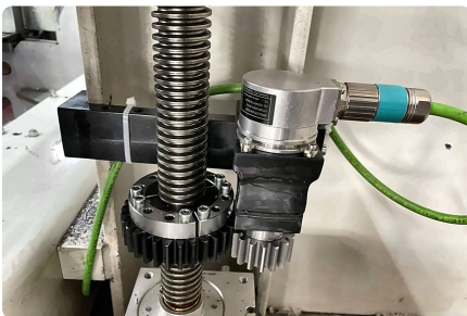
Absolutgeber am zweiteiligen Zahnrad.
