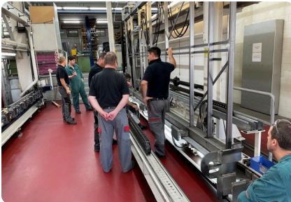
Die Richtmaschine bei der Inbetriebnahme.
