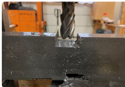
Nut, auf den Zehntelmillimeter genau eingefräst.
