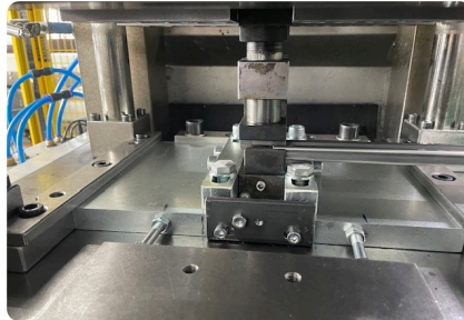
Neue Grundplatte von WIAP, darauf die bestehende Stanzeinheit.
