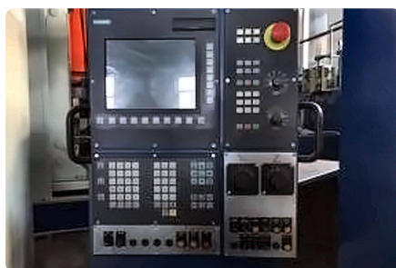
Neue CNC-Steuerung Sinumerik 802 DSL.
