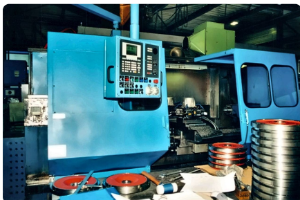
Graziano mit neuer Steuerung.
