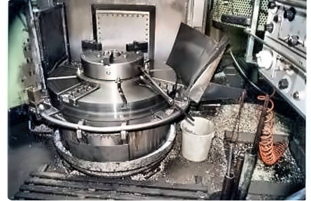
Späne-Einsammelring im Tisch.
