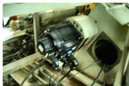
Neuer Vorschubantrieb, direkt aufgesetzt.
