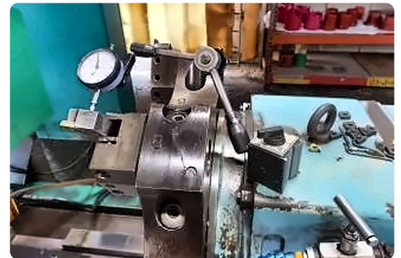
Prüfung des Revolvers: er muss spielfrei sein, sonst vibriert es.
