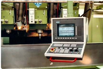
Neue CNC an einer Starrag-Fräsmaschine.
