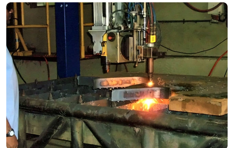
Brennschneiden einer dicken Stahlplatte.
