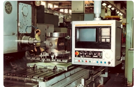
Neue Steuerung, beim Hersteller angebaut.
