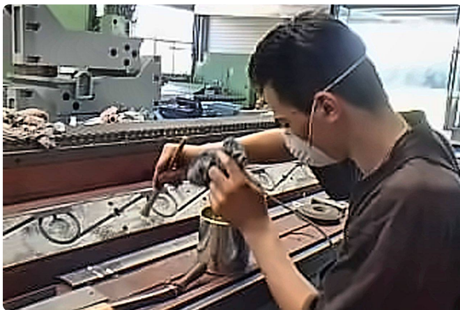
Der SKC-Belag wird neu ausgegossen, zuvor sorgfältig gereinigt.
