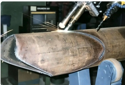
Sattelschnitt an einem Rohr.
