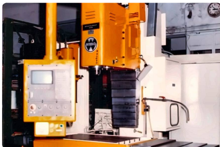
Vertikal-Bearbeitungszentrum mit Werkzeugwechsler.
