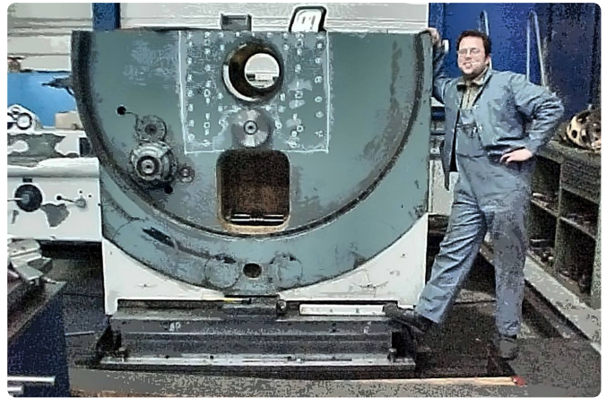
Der gerissene Spindelstock.
