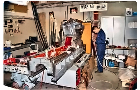
20-Tonnen-Schlitten: neue Belegung, Zahnräder neu eingeschabt.
