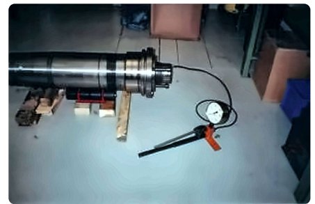
Lager mit Pressverband-Pumpe abgepresst, bis 2500 bar.
