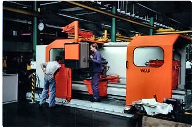
Nachher: CNC-Drehmaschine mit Vollverschalung und Späneförderer.
