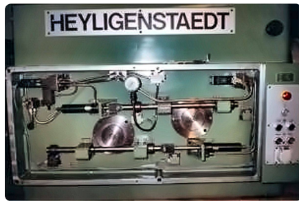
Schaltgestänge mit Zylinderansteuerung.
