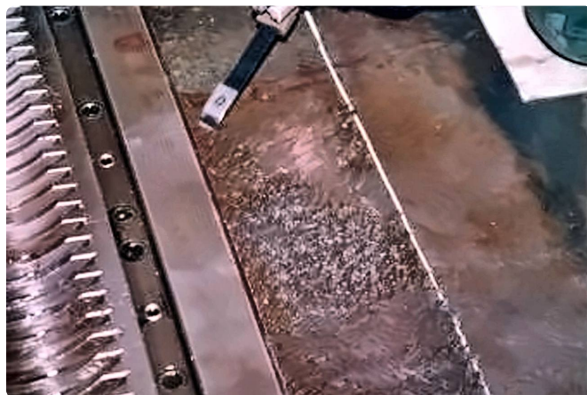
Pro Durchgang trägt man 0,002 bis 0,005 mm ab.
