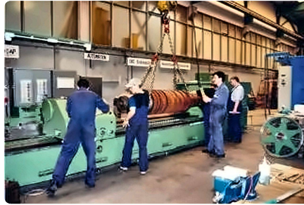
Walzentestdrehen mit Z-Kugelrollspindel 80 × 10.
