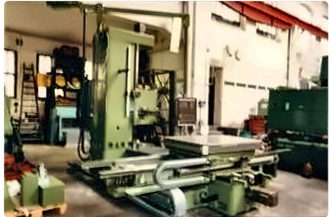
Das umgebaute Bohrwerk.
