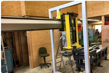
Hub-Senk-Schlitten mit V-Rollen, geführt auf zwei Vierkantrohren.
