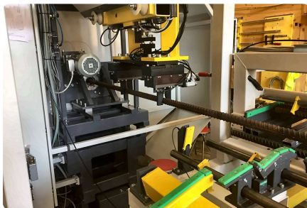
Doppelgreifer, zentriert das Werkstück exakt in der Maschine.
