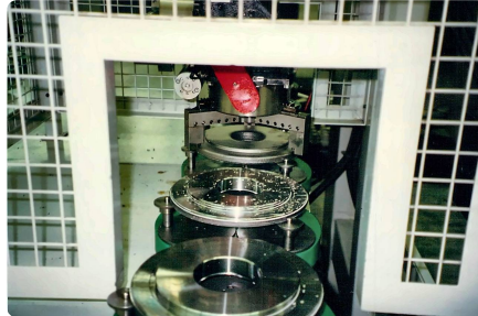
Rundtaktband mit zentraler Spannvorrichtung.
