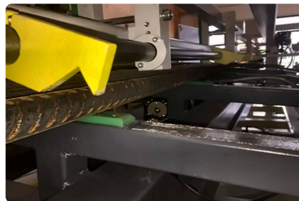
Kralle: Stange vom Rechen auf das Prisma.
