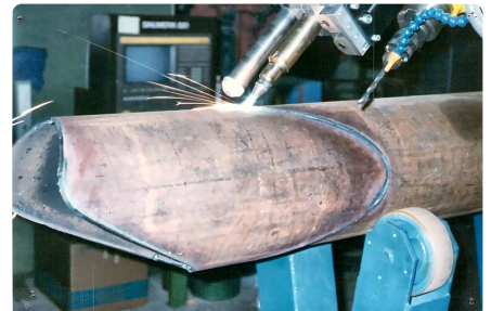
Plasmaschnitt an einem Rohrsattel.
