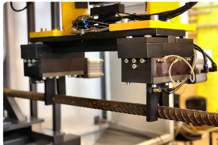
Eigenkonstruktion: HLV-Greifer für Werkstücke bis 40 kg.
