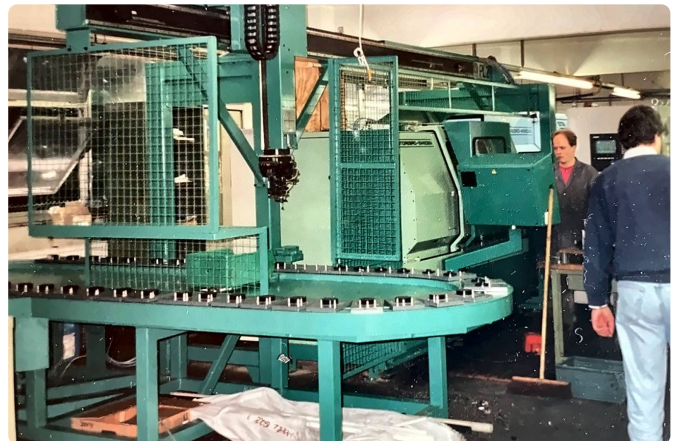
PL2 mit Palettierfunktion und Rundtakt-Palettenbahn.
