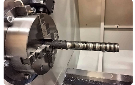
Planspiralfutter: kein Backenwechsel bei anderen Durchmessern.
