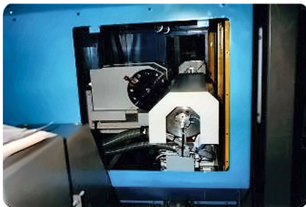
Zwei Spindelstöcke, in Z verfahrbar.
