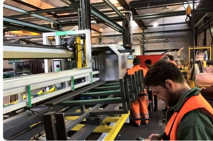
Beladeseite, ausgelegt für 50 Rohlinge.
