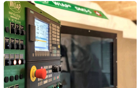
WIAP-Bedienpult mit Sinumerik.
