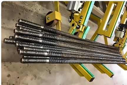
Fertig gerollte Gewinde auf der Ablage.
