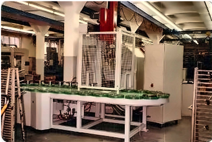
Eigen entwickelter Roh- und Fertigteilsspeicher.
