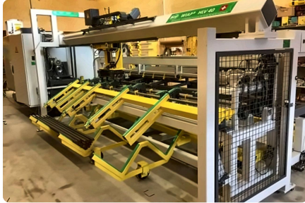
DM3S mit Hilfsladevorrichtung HLV für Stangen bis 4 m.
