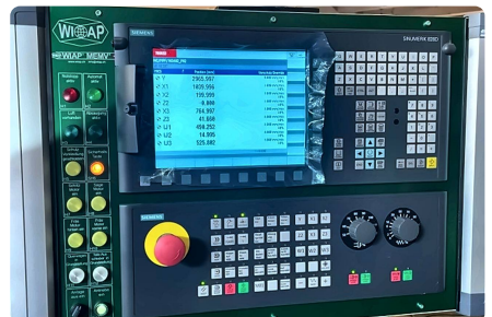
Sinumerik 828 mit WIAP-Bedienpult.
