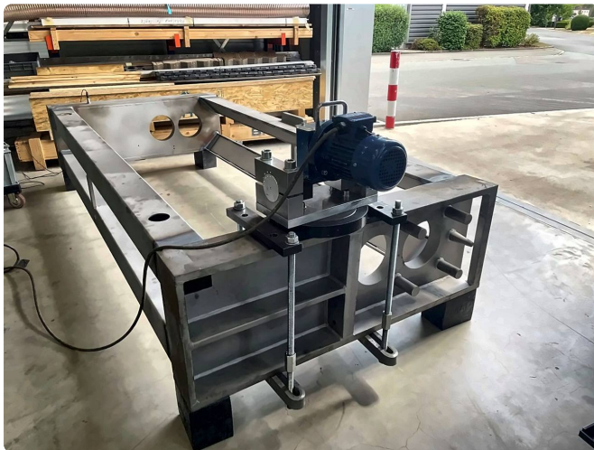
Maschinengestell: wird nicht mehr geglüht, nur noch MEMV® entspannt.
