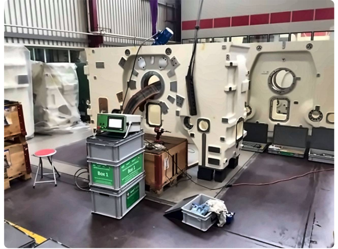
Grosses Gussgehäuse mit Verzug aus der Giesserei.
