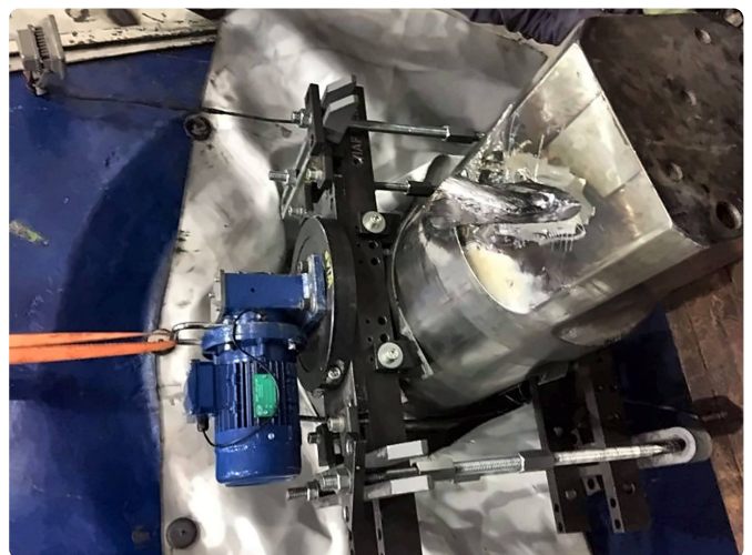
Riss einer grossen Presse wird beim Schweissen vibriert.
