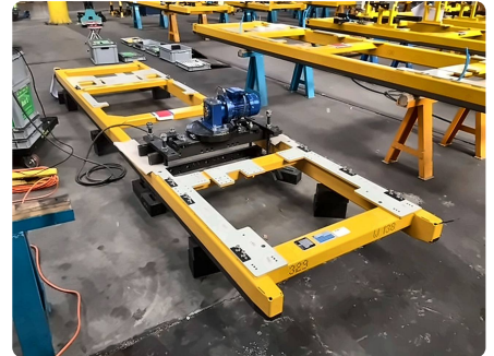
8 Gummi: Montage-Plattformen für die Autoindustrie.
