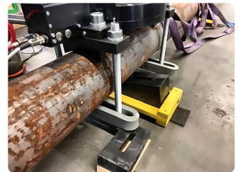
Rundstange mit Gummi-System aufgespannt.
