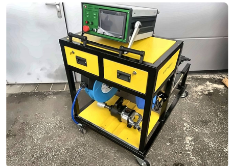
Gerätewagen Generation 4 mit Schlauchhaspel und Wartungseinheit. Der grosse Spannschrauber zieht die M36-Muttern fest.
