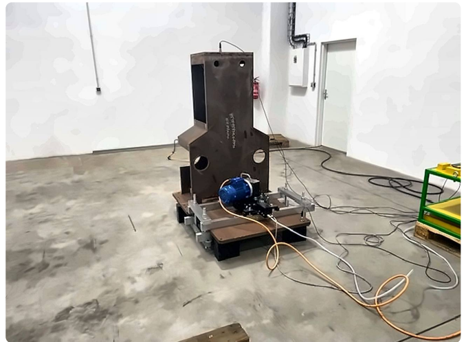
Aufspannung mit Langaufspannstangen, Querlocheisen, Gewindestangen und Briden.
