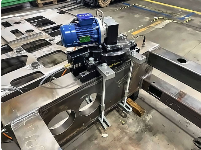
Anreger mit Drehvorrichtung auf dem Maschinengestell: Querspann-Distanzhalter, Querlocheisen, Gewindestangen und Briden.
