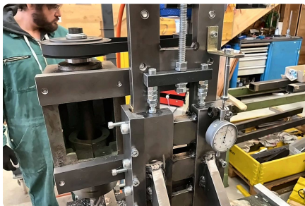
Verstellspindeln aus Gewindestangen, Einstellung mit 0,01-mm-Uhren.
