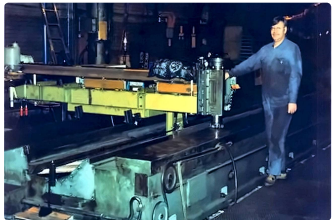
Fräsen der Bettführungen vor Ort. Das Foto ist älter, wir bitten die Bildqualität zu entschuldigen.
