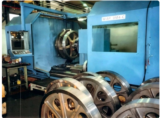
Zahnräder auf der WIAP DM4C in der Serienfertigung.
