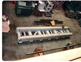
Maschinenbett vor der Montage.
