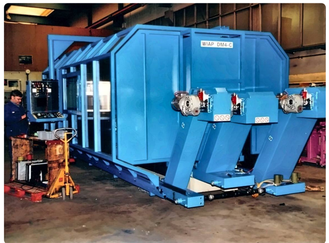
Drei Späneförderer und Ummantelung.
