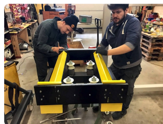
Montage des Laufwagens.
