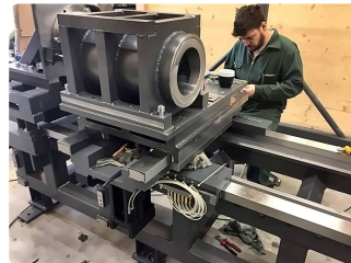
Zwei Spindelstöcke auf dem Schlitten.
