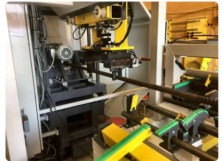
Portallader HLV hält Rohteil und Fertigteil bereit.
