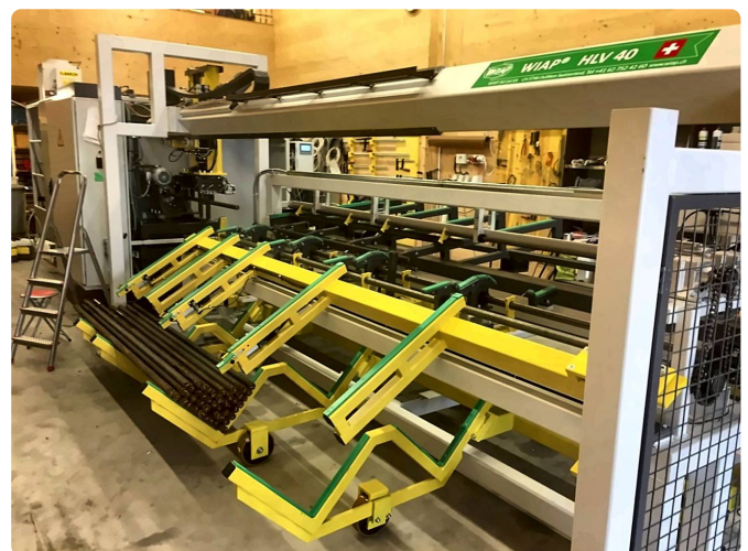
Portallader HLV und Rechen für Roh- und Fertigteile.
