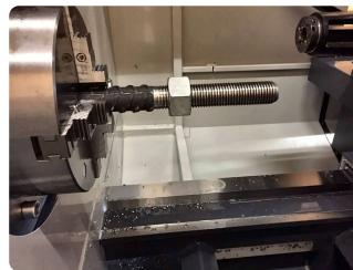
Gewindekontrolle direkt in der Maschine.
