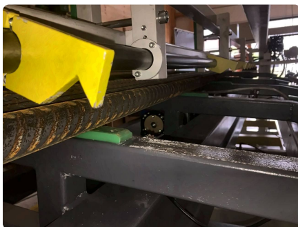
Kralle hebt die Stange auf das Prisma.
