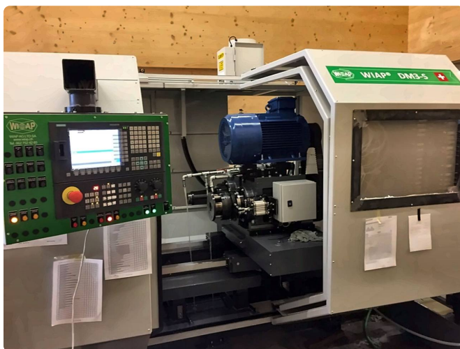
WIAP DM3S mit Bedienpult und Rollierkopf.
