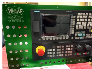
CNC-Frontplatte nach dem WIAP-System (Sinumerik 808).
