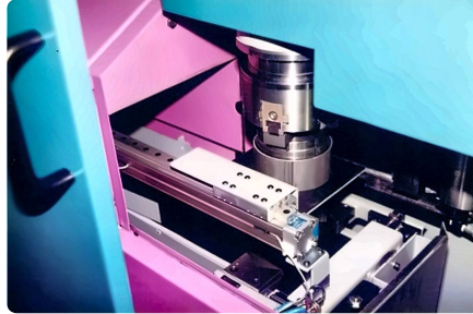
Fertigteil wird auf dem Ausschieber abgelegt, das Futter öffnet nach innen.
