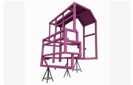
Rahmenkonstruktion der Verschalung. VISUALISIERUNG
