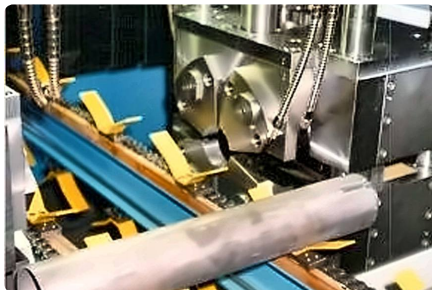
Schnellwechsel-Spannsystem für zentrische Rohraufnahme.
