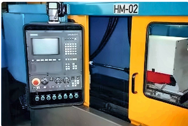
Steuerung: Sinumerik 810T GA2.
