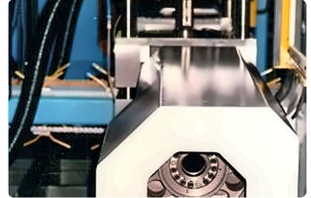
Zwei Spindelstöcke, in Z verfahrbar, Motor im Spindelstock.
