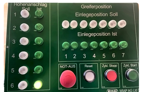
Anzeige für Höhenanschlag und Greiferposition.
