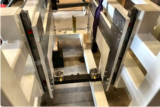
Frässlitten mit Antrieben vor dem Einbau.
