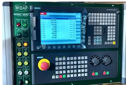
WIAP-Bedienpult mit Sinumerik.
