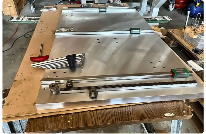
Grosse Platte aus Aluminium 7075 für den Y-Schlitten.
