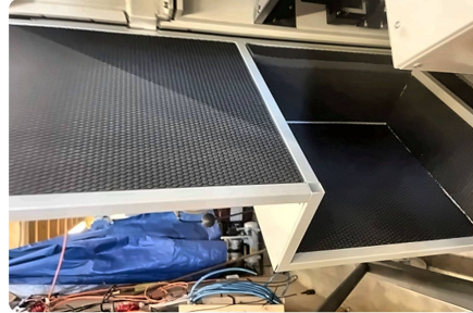
Lärmisolierte Innenseite einer Schutztüre.
