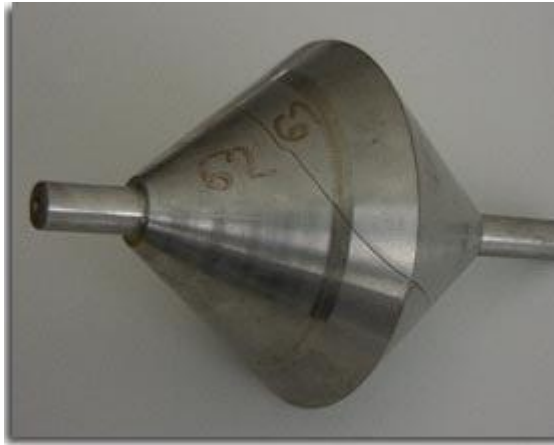
Eigenspannungsbedingter Riss in einem Kegelrad
