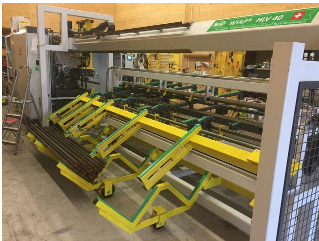
Bild 11: Der ganze Bund wird ohne manuellen Eingriff durchgearbeitet und die Fertigteil hinten in dem FT Bunker abgelegt. Wieder 50 Stk. Dann geht die Maschine in die Wartestellung.
