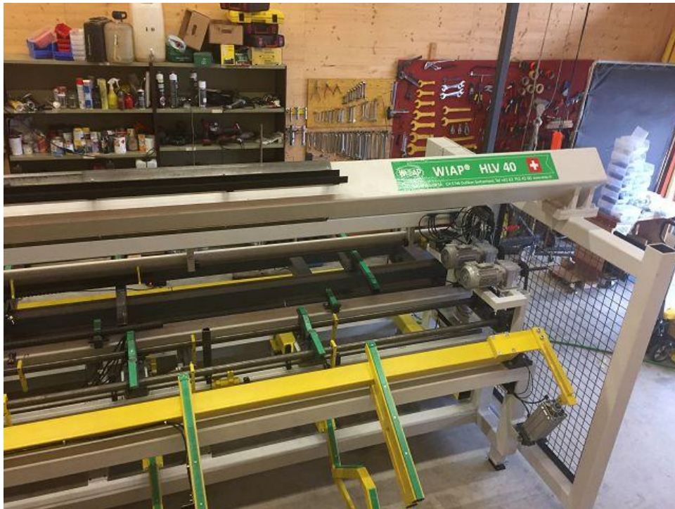
Bild 12 der HLV 40 heisst die Hilfsladevorrichtung 40 für 40 Kg Werkstückgewichte
