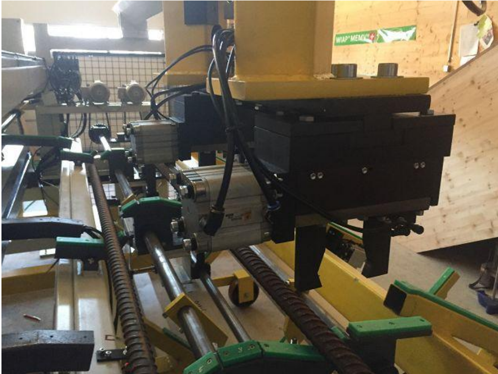
Bild 4: Das Fertigteil rechts wird abgelegt. Der Greifer hebt ab nach oben, dann dreht die FT Kralle und legt das Teil weg auf die FT Ablage. Dann wird das mit dem Vibrator auf die linke Ablage vibrierte Teil in die Mitte befördert mit der Rohteil Kralle. Der Greifer nimmt das Teil von der rechten Auflage auf.
