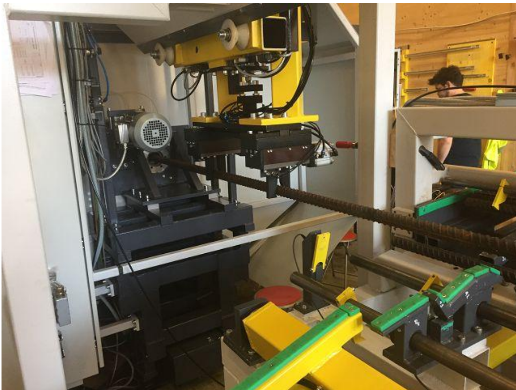
Bild 10: Danach wird das FT (Fertigteil) wieder aus der Maschine geführt mit dem HLV
