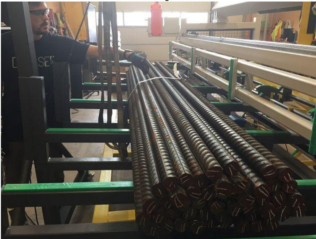
Bild 3: Jetzt wird der Bund aufgeschnitten und ohne manuelle Arbeit verteilt er sich selber durch eine besondere Vibrationstechnik mit einem Wiap für 5 Tonnen Werkstück Vibrator wird die Verteilung ausgeführt. Der Vibrator kann stufenlos von 0 bis 750 kg Anreger Energie eingestellt werden. Mit wenigen Test hatte die Wiap den Prozess im Griff. Der Erste Bund hat sich mit 3 kleinen Störungen durchgearbeitet, welche gleich behoben wurden.
