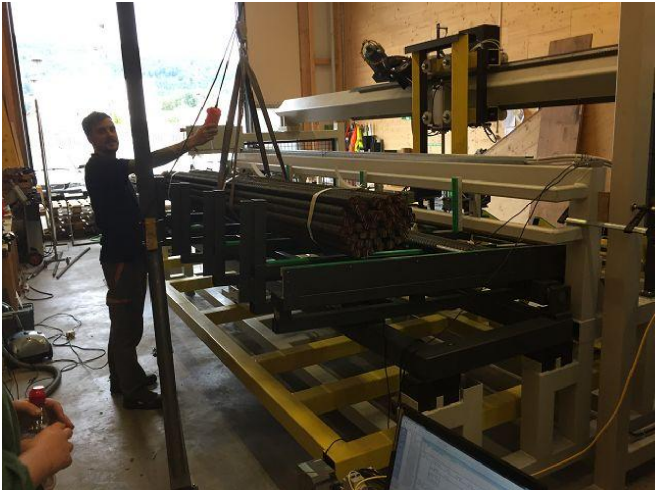
Bild 1: Hier wird ein Bund Fundament Roh Stangen auf die Automation gelegt 50 Stk bis 2 Tonnen schwer. Für Längen ab 1,6 Meter bis 4 Meter
