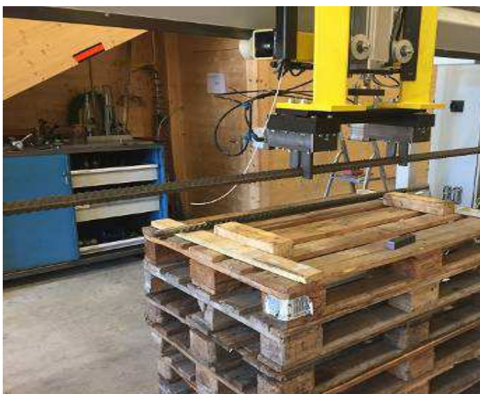
Bild 42: Test des Greifers mit dem HLV (Hilfsladevorrichtung)
