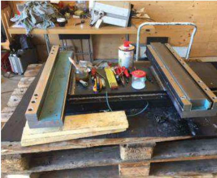
Bild 24: Gleitbelag Test mit Schmierbahnen vorher einfräsen
