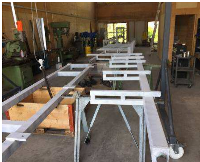
Bild 75: Alles wurde mit 2 Komponenten Farbe grundiert und gemalt
