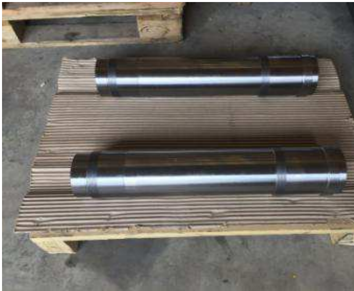
Bild 20: 2 identische Spindeln geschliffen
