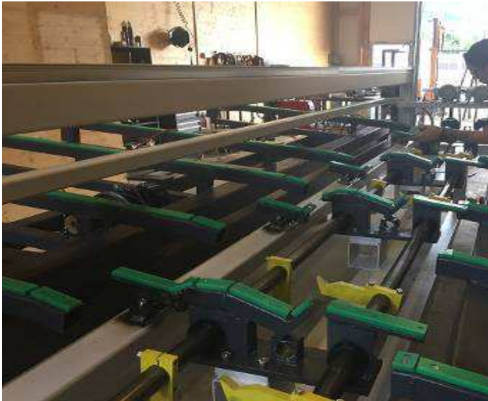
Bild 77: Verschleisskunststoff, schützt auch vor Lärm
