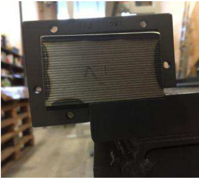
Bild 12: Abstreifer Sonderanfertigung für WIAP 40x70 für 3 Maschinen an Lager gekauft
