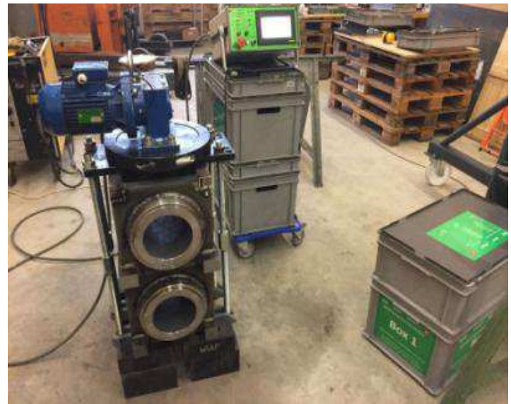
Bild 18: 3 Richtung MEMV Entspannen. Protokollieren der Entspannung beider Spindelstöcke
