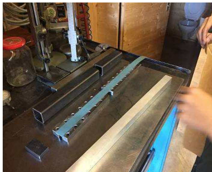
Bild 40: Der Untergriff. Damit es nicht Stahl auf Stahl ist, nehmen wir auch Gleitbelag
