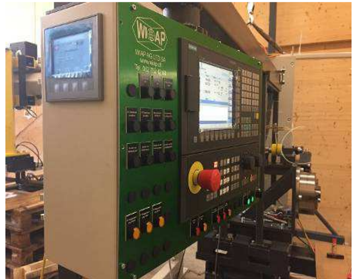
Bild 64: Da die CNC keine Analoge Ein und Ausgänge hat, haben wir eine SPS mit HMI Bedienung genommen. Es war einfacher als eine Poti Lösung zu machen. Die Werkzeugbruchüberwachung der Rollierwerkzeuge und Schälkopf Überwachung für alle Gewinde über M Funktion programmierbar. Wie die Futter Einstellung mit Amp. Und die Einstellung des Vibrators der Teilezuführung geht über die SPS mit HMI
