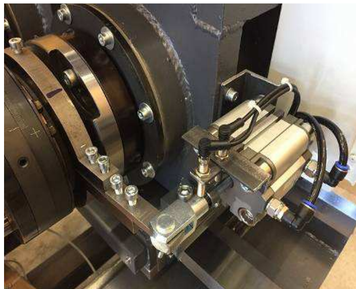
Bild 67: Normschalter, Normzylinder; pflegeleicht für den Unterhalt
