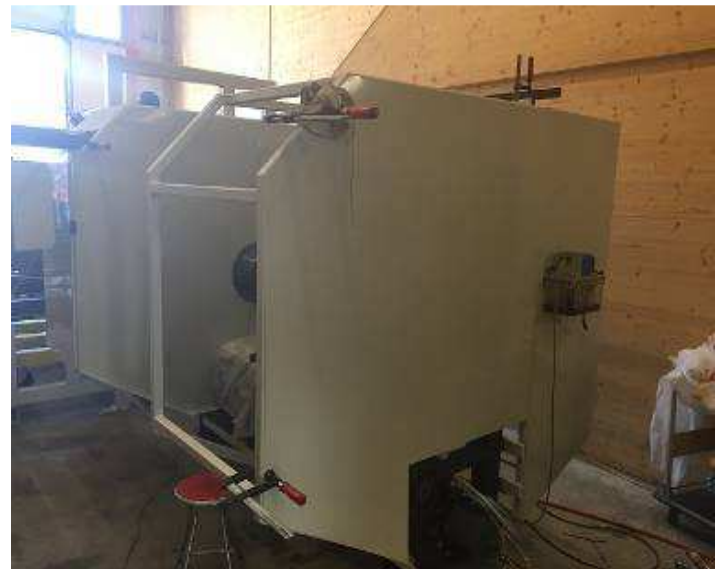
Bild 92: Die Wiap hat für die Sondermaschine ein System, dass viel mit einfachen Blechen gemacht werden muss. Es ist weniger schön als bei Grosserienmaschinen, aber es erfüllt den Zweck
