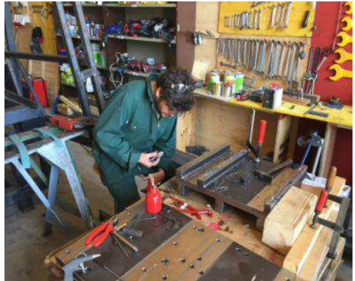
Bild 26: Viele Gewinde M8x1 für die Schmieranschlüsse. Am X Schlitten
