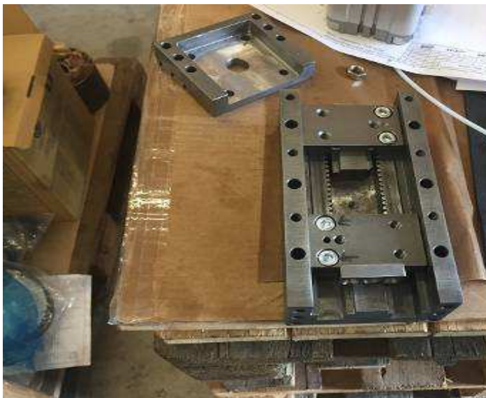
Bild 37: Der Parallel Greifer 2 St. WIAP Eigenkonstruktion
