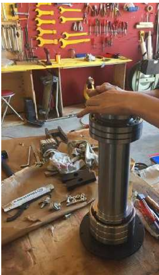
Bild 53: So jetzt noch die Montage der 2 Hauptspindeln
