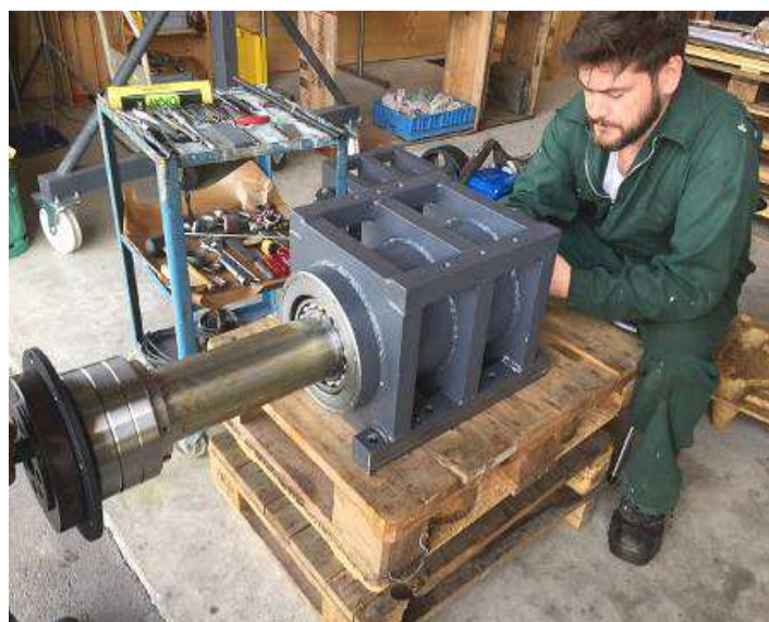
Bild 55: Kein Hammer bei der Montage, alles mit Montage Hilfsvorrichtungen
