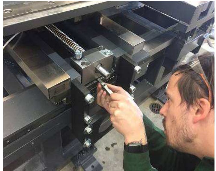
Bild 47: Jim, Montage der X Spindel
