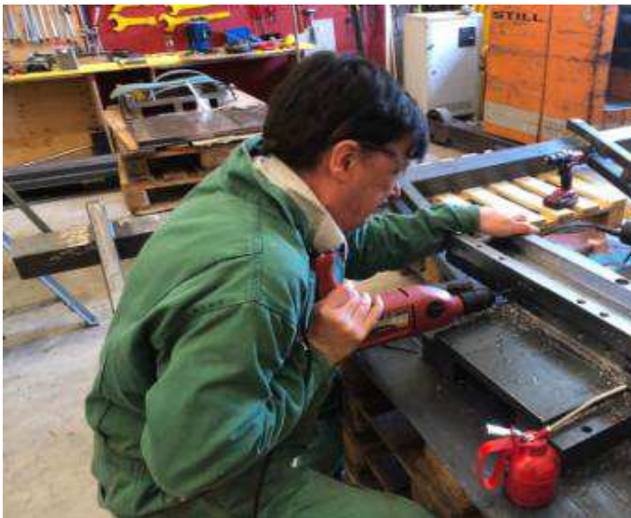
Bild 25: 150 mm tief bohren für die Schmierung
