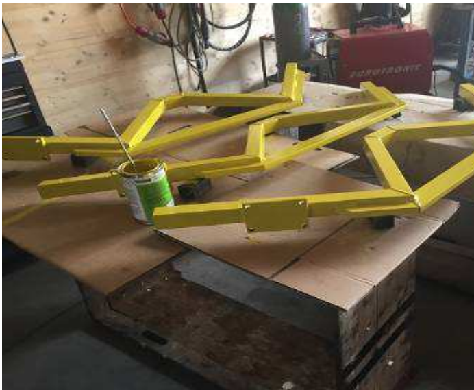
Bild 82: Die Fertigteil Ablagen Pysmen 50 Stangen a 40 kg müssen da rein
