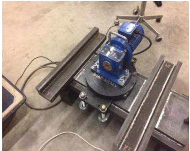
Bild 22: Hier wird der Z-Schlitten MEMV in 4 Achsrichtungen vibrationsentspannt
