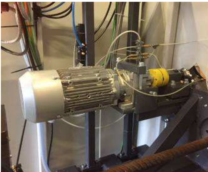
Bild 98: Futter Antrieb für 180 Nm. Alle Durchmesser ohne Backenwechsel möglich. Futter kann beliebig, genügend geöffnet werden, um ohne Störkontur mit dem Lader ins Futter von hinten fahren zu können. Die Schmierleitungen werden jetzt noch sauber verlegt. Das Futter wie der Antrieb wird alles automatisch geschmiert
