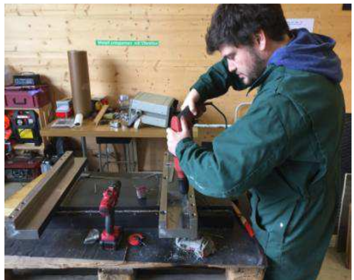
Bild 23: Mehrere hundert mm Schmierkanäle bohren, dass der Eintritt nur auf einer Seite pro Bahn ist
