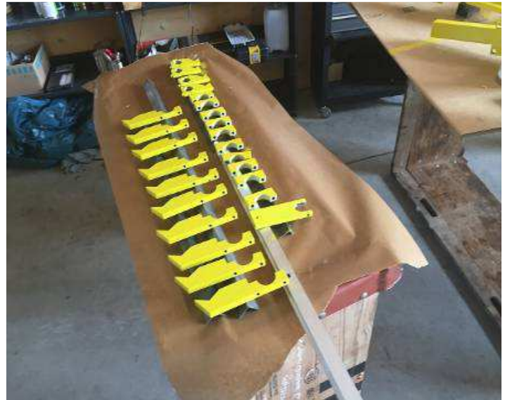
Bild 83: Die Krallen um das Rohteil und Fertigteil in die Auflage zu drehen. Was bewegt, gelb
