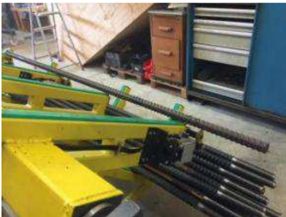
Bild 53: Der Fertigteil Halter senkt langsam ab, Hauptzeitparallel und öffnet unten die Kralle, damit die Gewindeseite erst später herunter fällt.
