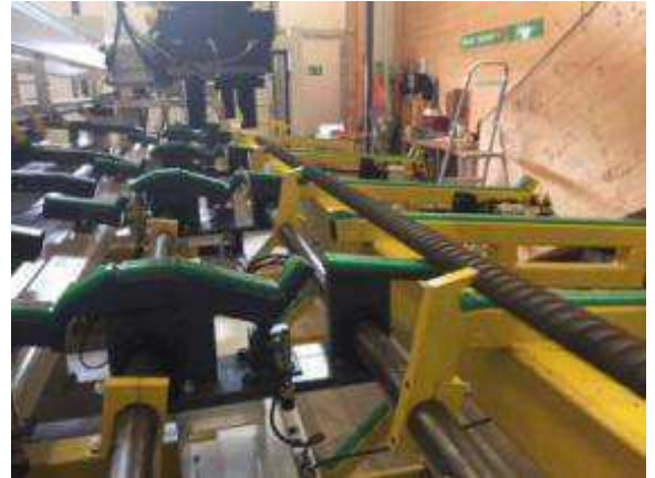
Bild 50: Das Fertigteil wird mit den Drehkrallen weggehoben.
