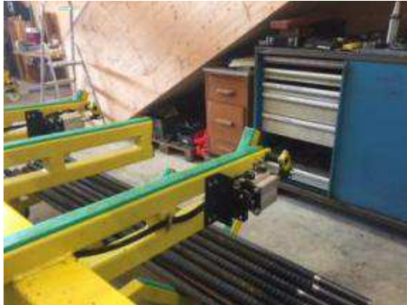
Bild 48: Die Fertigteil Kralle hebt sich nach oben, damit das Fertigteil abgefangen werden kann, das heisst, nicht unkontrolliert auf die Fertigteile fallen. Der vorderste Zylinder, gewindeseitig, senkt verzögert ab, so dass das Werkstück nicht auf das Gewinde fällt und dadurch verletzt wird.
