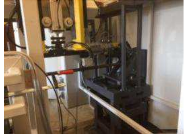
Bild 27: Das Spannfutter in der Maschine wird über einen Getriebemotor, welcher 180 Nm erreichen kann, geschlossen und geöffnet.
