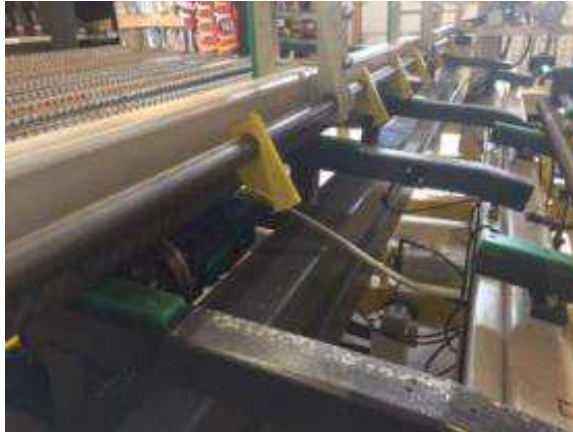
Bild 9: Der Rohteilhalter wartet auf Rohteile.
