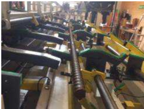
Bild 13: Das Rohteil fällt auf die Vorablage Position. Auch wenn 3 Werkstücke zusammen kommen, stört es nicht, weil die Rohteil Kralle dann die endgültige Vereinzelung macht. Die Vereinzelung ist nötig, damit der Greifer beim Absenken keine Störkontur hat. 2 Lichtschranken melden Werkstück in Vorablage, Position vorhanden. Die Rohteil Kralle kann nur drehen, wenn da beide Lichtschranken betätigt sind.
