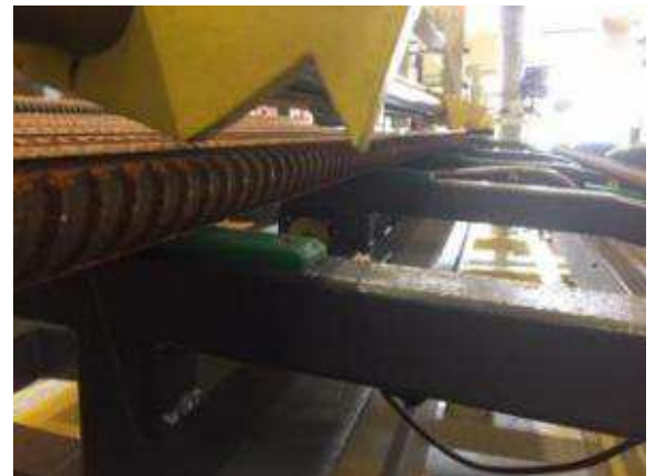
Bild 12: Wenn beide Lichtschranken betätigt sind, öffnet die Rohteil Halterung mit einem Zylinder. Schliesst aber sofort wieder, wenn ein Teil durchgelaufen ist, was auch mit einer einzelnen Lichtschranke geprüft wird.
