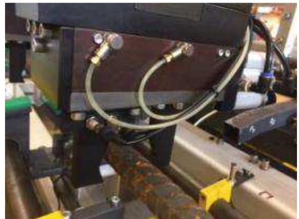
Bild 24: Die WIAP Greifer für 40 kg schliessen selbstzentrierend. Sie werden mit 4 Annäherungsschalter überwacht. Wenn kein Werkstück vorhanden ist, schalten die inneren Schalter und es gibt eine Alarmmeldung. Wenn ok, hebt der Greifer wieder 150 mm an.
