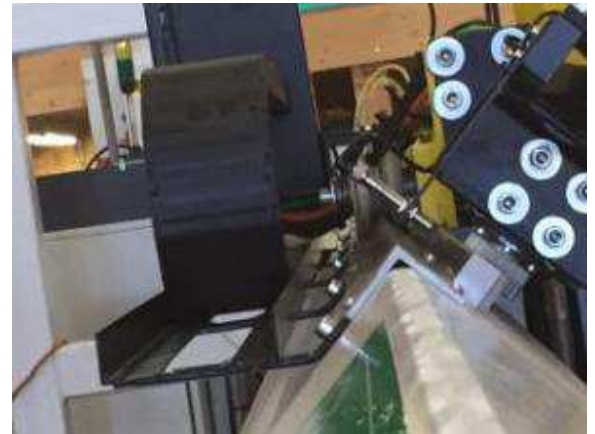
Bild 45: Die Zahnstangen Endlagenüberwachung verhindert, dass wenn einmal der Y Achs Motor entfernt würde und die Maschine die Position verliert, dass kein ungewolltes über die Zahnstangen Fahren möglich ist. Die Maschine benötigt kein Referenzpunkt anfahren mehr. Sie weiss immer, wo sie ist, solange der Motor mit dem integrierten Messsystem nicht demontiert wird, ohne Kennzeichnung.
