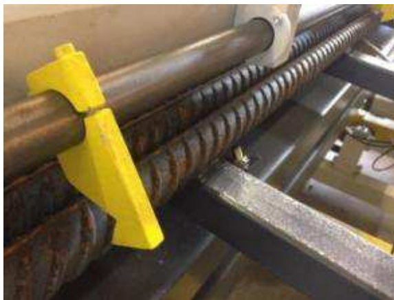
Bild 10: Die Rohteile kommen langsam nach vorne. Sie werden mit dem Rohteilhalter gehalten. Erst wenn die 2 Lichtschranken betätigt sind, kann der Halter öffnen. Das verhindert, dass die Teile schräg durch die Halterung gehen. Es kann sein, dass mehrere Teile gleichzeitig kommen. Was jedoch nicht stört, weil die Konstruktion dafür ausgelegt ist.
