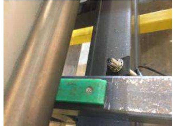
Bild 11: Solche 2 Lichtschranken überwachen, ob das Werkstück vorhanden ist. Vorne bei 500 mm und bei 1500 mm. Die Lichtschranken können eingestellt werden von 0 bis 150 mm Schaltzone.
