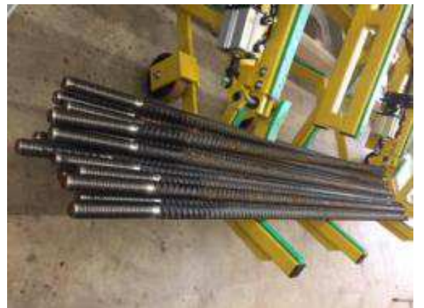
Bild 55: Fertig bearbeitete Werkstücke Gewinde Länge 180 mm M36x4. Ablage für 50 St.
