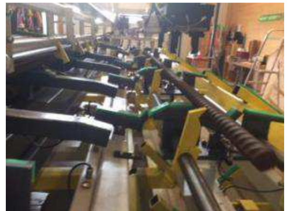
Bild 14: Wenn das Werkstück in der Vorablage Position ist, dreht die Rohteil Kralle über eine M Funktion das Werkstück in die Mittenposition.
