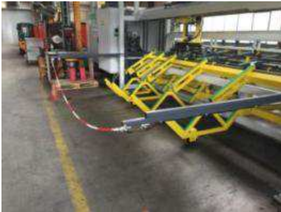
Bild 58d: Die ganze Anlage ist mit Horn und Stopp Zonen gesichert. Die Kette verhindert, dass unwissende Dritte in die Gefahrenzone kommen. Wenn jemand in die Stoppzone läuft, stoppt die ganze Anlage. Es gibt ab und zu Leute, welche zu nahe kommen, weil sie antasten wollen, was sie sehen.
