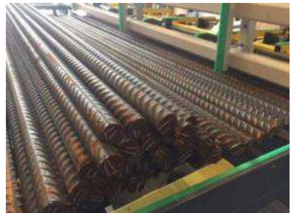
Bild 4: Wenn der Bund aufgeschnitten ist, wird mit der M Funktion M89, eine automatische Ablaufausbau Software dafür gesorgt, dass sich der Bund störungsfrei von selber verteilen wird.
