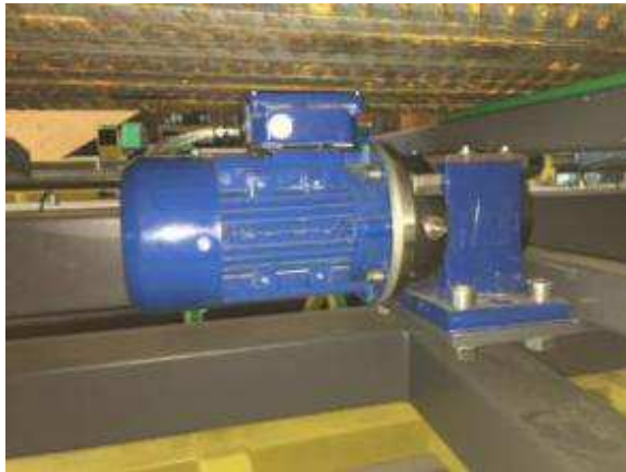
Bild 5: Der Vibrator WIAP V05 sorgt für das. Eingestellt wird dies mit 2 St. 6 mm Inbusschlüsseln.
