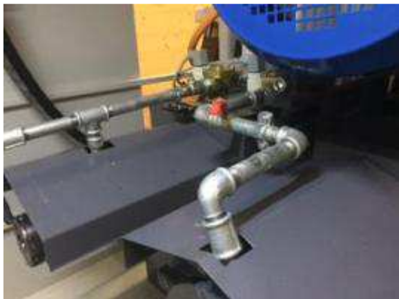
Bild 41: Der Rollierkopf kann mit dem Wassermengenregler eingestellt werden.
