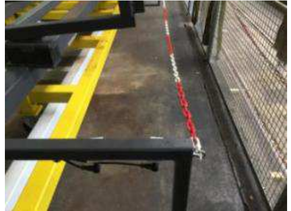
Bild 58e: Rohteil Zuführseite ist auch kontrolliert. Zuerst kommt die Hornzone und 150 mm weiter wird mit Stopp die Anlage stillgelegt. Auch hier noch eine Kette für Aussenstehende.
