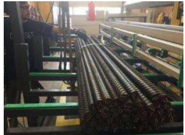
Bild 3: Der Bund wird aufgeschnitten und ohne manuellen Einsatz verteilt er sich selber durch eine besondere Vibrationstechnik. Mittels eines Wiap Vibrators V05 (für Werkstückgewicht bis 5 Tonnen) wird die Verteilung ausgeführt. Der Vibrator kann stufenlos von 0 bis 750 kg Anreger Energie, eingestellt werden.
