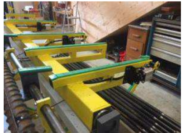
Bild 47: Der Ablage „Rechen“ fährt nach oben über das CNC Programm. In der Nebenzeit mit einer M Funktion.
