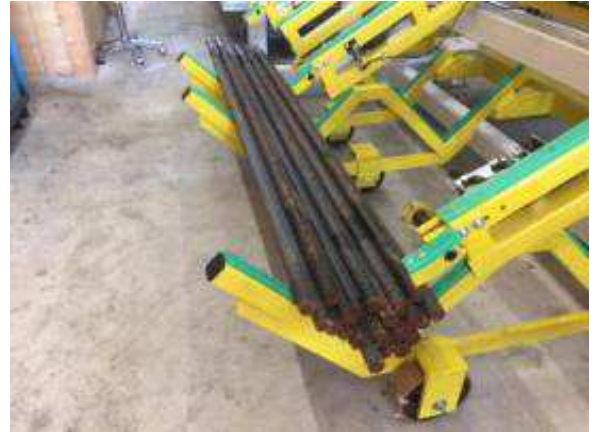
Bild 54: Der ganze Bund wird ohne manuellen Eingriff durchgearbeitet und die Fertigteil hinten in dem Fertigteil Bunker abgelegt. Wieder 50 St. Dann geht die Maschine in die Wartestellung.
