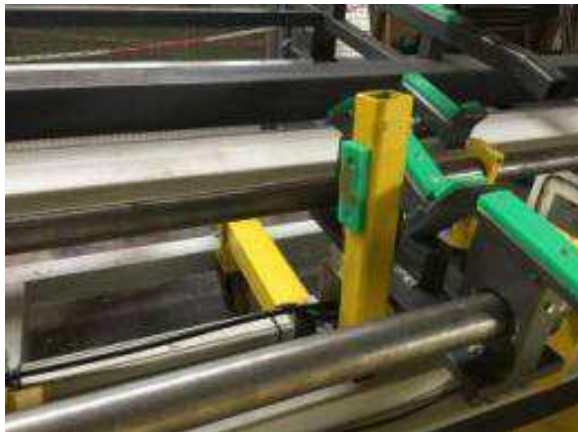
Bild 18: Der Andrücker drückt bis das Rohteil am Frontschalter ist.
