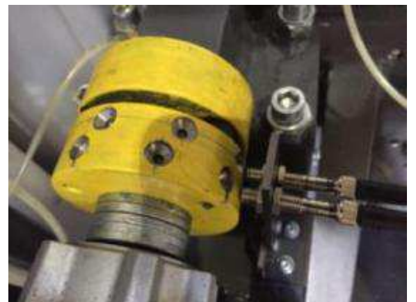
Bild 28: Die Futterspannung geht mit einem 180 Nm Getriebemotor. Alle wichtigen Elemente sind zwangsgeschmiert. Ein Impulszähler, 8 pro Umdrehung, öffnet das Futter; im Eilgang 51 Impulse. Das heisst, 6,3 Umdrehungen. So hat die Fundamentstange keine Kollision, wenn sie im Schnellgang in die Maschine fährt. Dann schliesst es mit 45 Impulsen im Eilgang, dann langsames schliessen. Der Doppelschalter dient zur Kontrolle, ob es vorwärts oder rückwärts rotiert.
