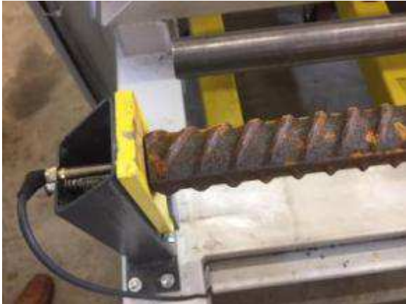
Bild 21: Der Schalter ist für die Prozesssicherheit wichtig. Das Rohteil kann auf 0.1 mm in das Futter gebracht werden.
