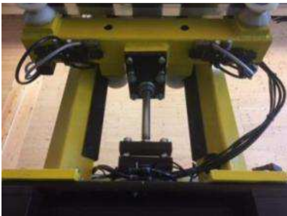
Bild 22: Der Greifer senkt dann 150 mm ab, die Greifer, welche überwacht sind, schliessen.
