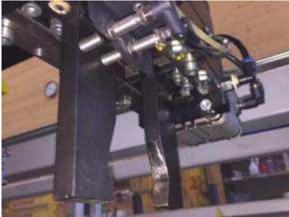
Bild 25: Greifer Überwachung. Offen wird geprüft. Ganz Innen = kein Werkstück oder Zu und kein Schalter ist ok. Beide Greifer links und rechts mit derselben Überwachung.
