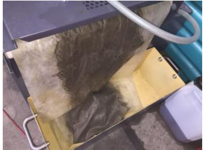
Bild 57c: Dann läuft der Filter automatisch nach.
