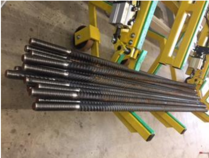
Bild 55: Fertig bearbeitete Werkstücke Gewinde Länge 180 mm M36x4. Ablage für 50 Stk.
