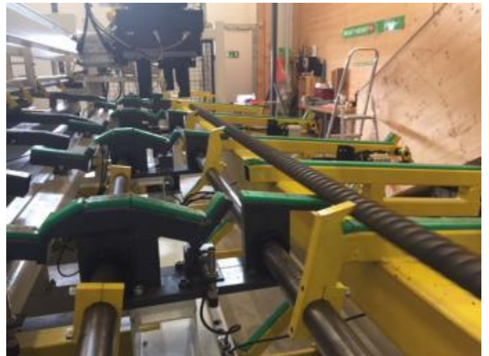
Bild 50: Das Fertigteil wird mit den Drehkrallen weggehoben.
