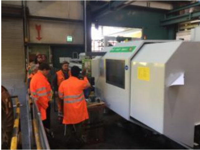
Bild 61: Zeitmessung der Maschine beim Kunden. Die Anlage läuft mit der 2,8 Meter Stange 12 Sekunden zu schnell. Und es gibt die Möglichkeit noch 30 Sekundenschneller zu werden. Dies ist aber nicht nötig, weil die Anlagen so oder so zu schnell ist.
