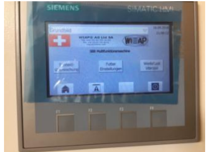
Bild 7a: Am CNC Bedienpanel, seitlich, ist eine zusätzliche Bedienungstafel. Hier können 3 Bediengruppen für den Bediener gewählt werden. Doch eigentlich sind keine Einstellungen notwendig.
