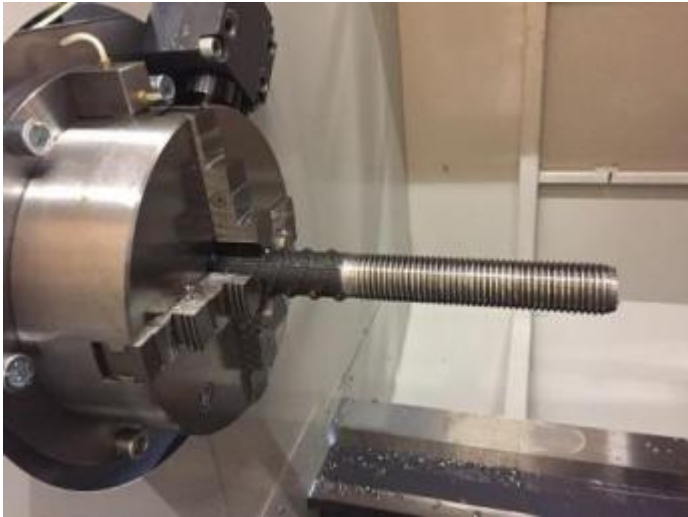
Bild 43: Das fertige Werkstück. Hier M36x4 180 mm Gewindelänge. Backen Anfang bis Gewinde Ende ist immer 50 mm. Je nach Gewindelänge wird alles automatisch über Parameter berechnet. Der Operatuer hat keine Aufgabe etwas einzugeben im CNC Programm. Ausser: Gewinde Durchmesser (für die Drehzahl Berechnung), Steigung und Länge des Gewindes und Länge des Werkstückes.
