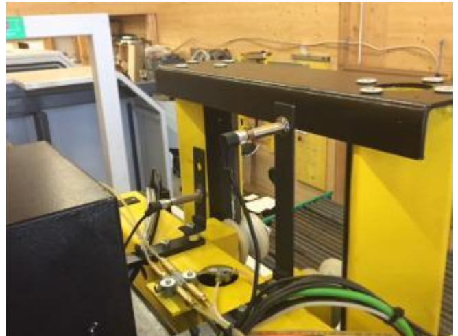
Bild 23: 2 Lichtschranken prüfen, ob die Greifer oben oder unten sind.
