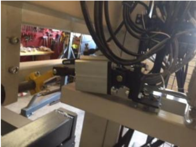
Bild 8: Der Rohteilhalter mit einem 60-er Zylinder, sorgt dafür, dass ein Werkstück kontrolliert nach vorne wandern kann.
