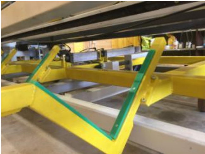
Bild 55a: Zylinder 80 mm, Durchmesser 80 schieben den Fertigteilwagen, je nach M Funktion im CNC Programm, in die richtige Position.
