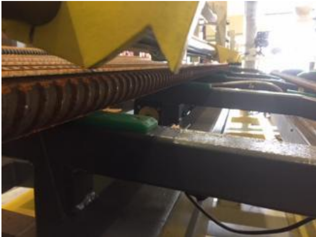
Bild 12: Wenn beide Lichtschraken betätigt sind, öffnet die Rohteil Halterung mit einem Zylinder. Schliesst aber sofort wieder, wenn ein Teil durchgelaufen ist, was auch mit einer einzelnen Lichtschrake geprüft wird.
