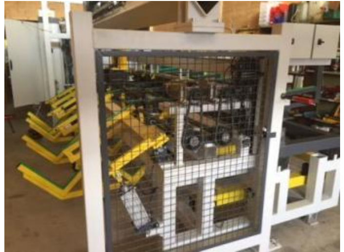
Bild 49: Danach dreht die Fertig Kralle das linke Kettenrad unter dem Schutzgitter und legt das Teil weg auf die Fertigteil Ablage, welche für diese Aufgaben oben stehen muss.
