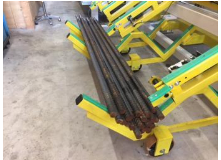
Bild 54: Der ganze Bund wird ohne manuellen Eingriff durchgearbeitet und die Fertigteil hinten in dem Fertigteil Bunker abgelegt. Wieder 50 Stk. Dann geht die Maschine in die Wartestellung. Der fertige Bund kann dann mit dem Stapler oder dem Kran aus dem Fertigteil Bunker entfernt werden. Idealerweise am besten gleich hier schon binden.
