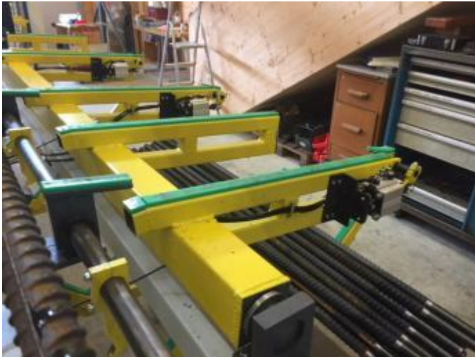
Bild 47: Der Ablage „Rechen“ fährt nach oben über das CNC Programm. In der Nebenzeit mit einer M Funktion.
