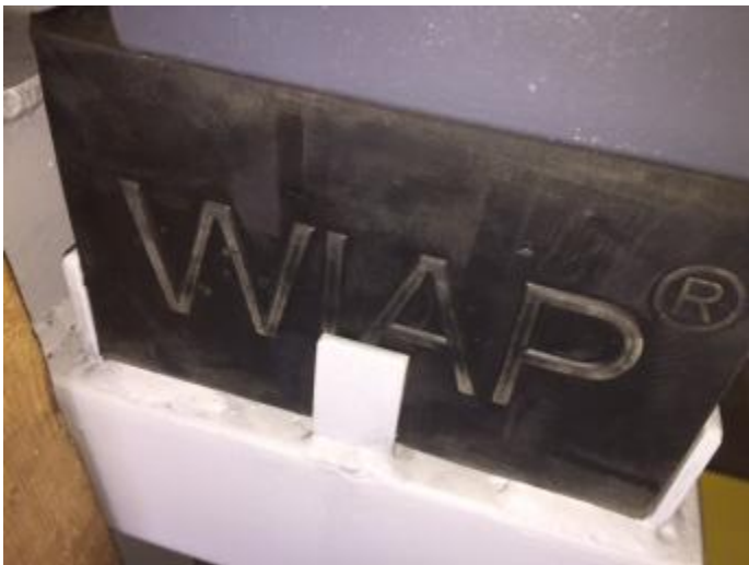
Bild 7: Dank der grossen Gummi Dicke ist die Dämpfung sehr gut. Das Oberteil vibriert, das Unterteil bleibt ruhig.
