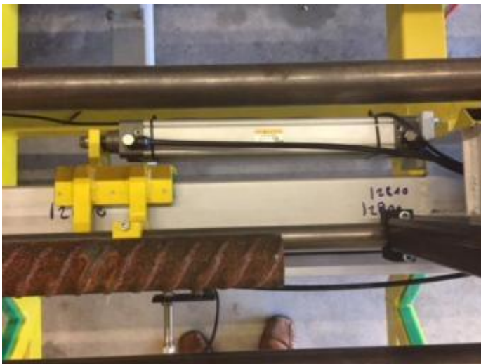
Bild 17: Der Werkstück Andrücker, welcher nur mit einem Handgriff innert Sekunden für die einzelnen Stangenlängen umgesteckt werden kann, schiebt jetzt das Werkstück nach vorne, wenn die beiden Schalter betätigt sind, dass ein Werkstück vorhanden ist.
