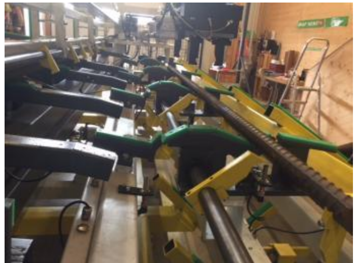
Bild 15: Das Rohteil liegt jetzt in der Aufnahme Prysma Grundstellung.
