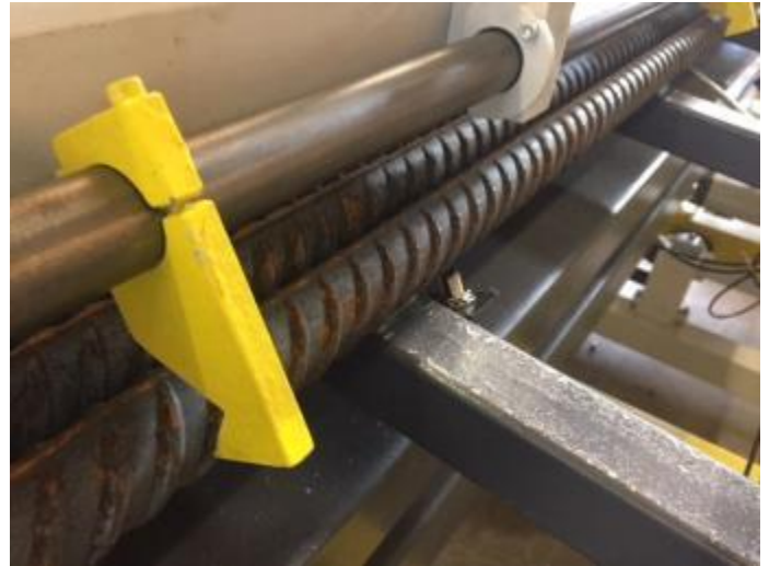
Bild 10: Die Rohteile kommen langsam nach vorne. Sie werden mit dem Rohteilhalter gehalten. Erst wenn die 2 Lichtschraken betätigt sind, kann der Halter öffnen. Das verhindert, dass die Teile schräg durch die Halterung gehen. Es kann sein, dass mehrere Teile gleichzeitig kommen. Was jedoch nicht stört, weil die Konstruktion dafür ausgelegt ist.
