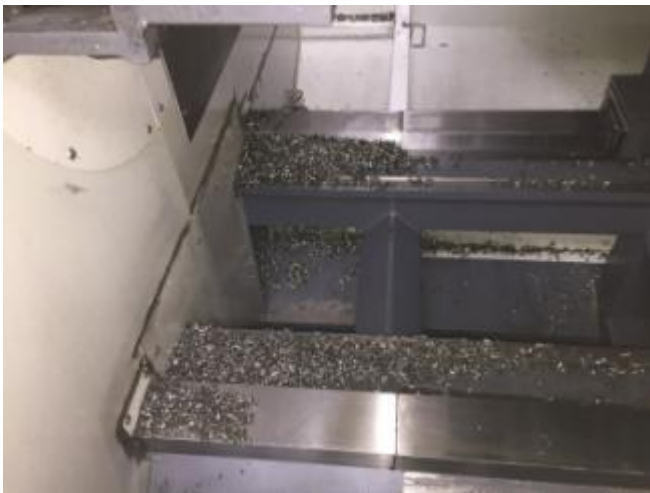
Bild 43a: Eine Funktion schwemmt die Späne weg; diese ist hier noch nicht programmiert.
