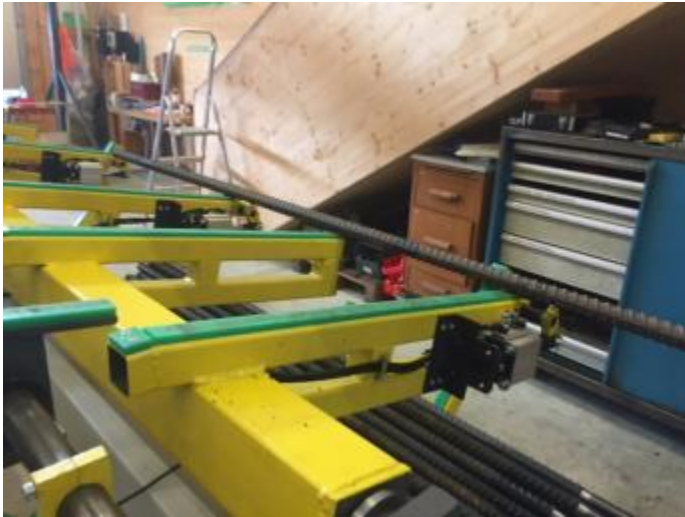
Bild 51: Das Fertigteil hält hinten am Anschlag an.
