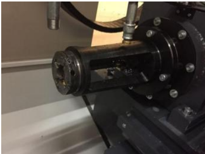
Bild 30: In der Maschine wird das Teil mit dem Futter gespannt und dann mit einem 4 Schneiden Werkzeug geschält. Das Werkzeug schält vorne mit 4 Platten. Jede fährt mit 0,17 mm Vorschub, das ergibt bei 4 Platten 0.68 mm pro Umdrehung. Hinten ist noch ein Anfaser, der den Einlauf für die Rollen anfasen tut. Er macht eine 20° Fase. Der Anfaser muss jeweils von Hand für die unterschiedlichen Längen eingestellt werden. Die Drehzahl wird abgesenkt und der Vorschub um den Faktor 0.6 reduziert, wenn 7 Schneiden gleichzeitig im Eingriff sind.
