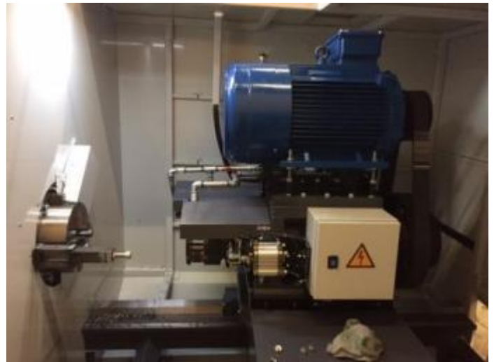
Bild 42: Der Druckbolzen neben dem Futter öffnet den Rollkopf mechanisch, wenn er vorne die Ausklink Position erreicht hat.
