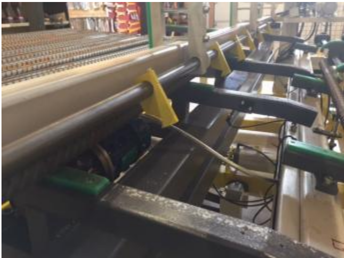
Bild 9: Der Rohteilhalter wartet auf Rohteile.
