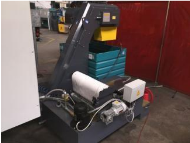
Bild 57a: Eine Bandfilteranlage sorgt dafür, dass der Roststaub die Rollen der Rollieranlage nicht hindert beim Langzeitlauf.
