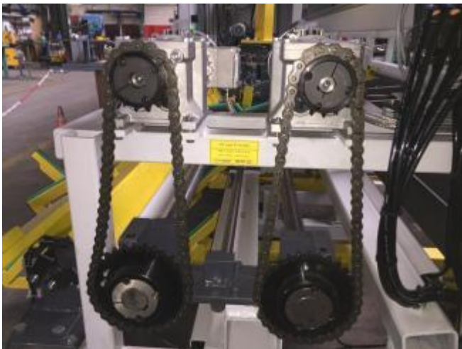
Bild 14b: Die Rohteil Kralle und Fertigteil Kralle werden über 2 Zentralstangen angetrieben. Die Grundstellung ist immer, wenn diese aus der Gefahrenzone senkrecht nach unten stehen.
