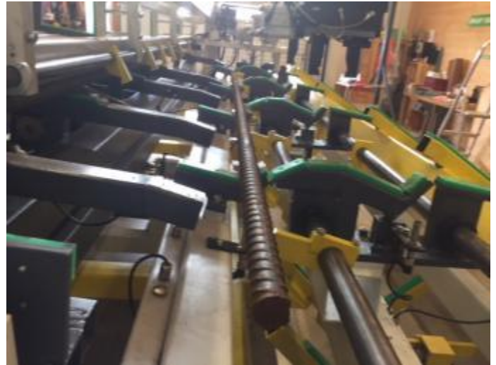
Bild 13: Das Rohteil fällt auf die Vorablage Position. Auch wenn 3 Werkstücke zusammen kommen, stört es nicht, weil die Rohteil Krallen dann die entgültige Vereinzelung macht. Die Vereinzelung ist nötig, damit der Greifer beim Absenken keine Störkontur hat. 2 Lichtschraken melden Werkstück in Vorablage, Position vorhanden. Die Rohteil Krallen kann nur drehen, wenn da beide Lichtschraken betätigt sind.
