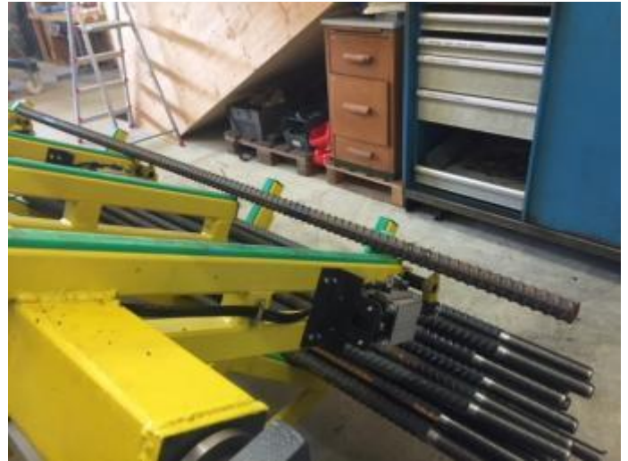
Bild 53: Der Fertigteil Halter senkt langsam ab, Hauptzeitparallel und öffnet unten die Krallen, damit die Gewindeseite erst später herunter fällt.
