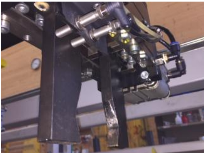
Bild 25: Greifer Ueberwachung. Offen wird geprüft. Ganz Innen = kein Werkstück oder Zu und kein Schalter ist ok. Beide Greifer links und rechts mit derselben Ueberwachung.
