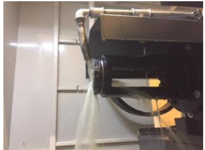
Bild 31: Der Schälkopf wird mit Emulsion gekühlt, M07 Schälkopf, M08 Rollierkopf.
