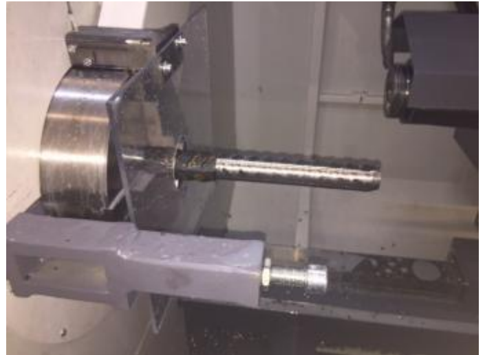
Bild 35. Nach dem Schälen sieht das Fertigteil, bereit zum Rollieren, so aus. Durchmesser minimal unter Flankendurchmesser. Zu bemerken ist, die Teile sind magnetisch. Ab und zu bleiben Späne, durch den Magnetismus am Teil hängen. Eine Schutzhaube deckt das ganze Futter ab.
