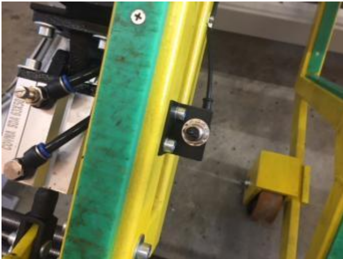
Bild 52: Wenn das Fertigteil an der Fotozelle vorbei ist, kann es erst absenken.
