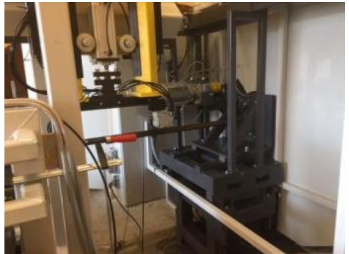
Bild 27: Das Spannfutter in der Maschine wird über einen Getriebemotor, welcher 180 Nm erreichen kann, geschlossen und geöffnet.
