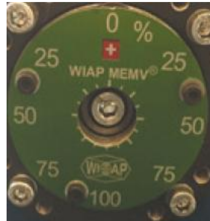
Bild 5a: Die Exzenter Stufe kann mit dieser Skala eingestellt werden von 0 auf 100%
