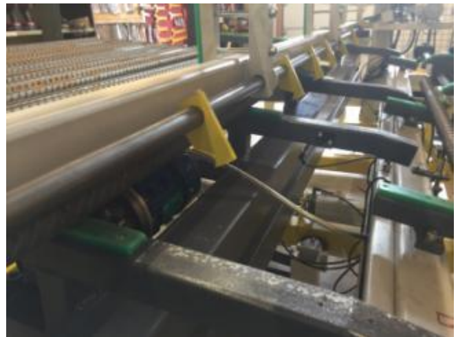
Bild 13a: Hier sieht man rechts die Lichtschraken in der Vorablage Position.
