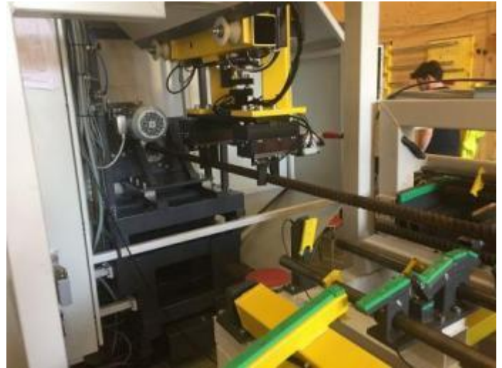
Bild 26: Hier wird das Werkstück in die Maschine mit dem HLV Lader gefahren.
