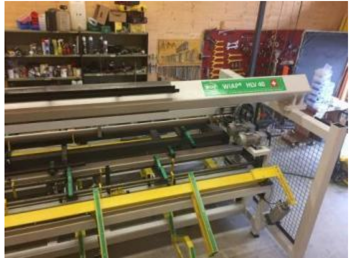
Bild 56: HLV 40 heisst die Hilfsladevorrichtung 40, für 40 kg Werkstückgewichte. Die maximale Länge der Teile kann 4010 mm sein.
