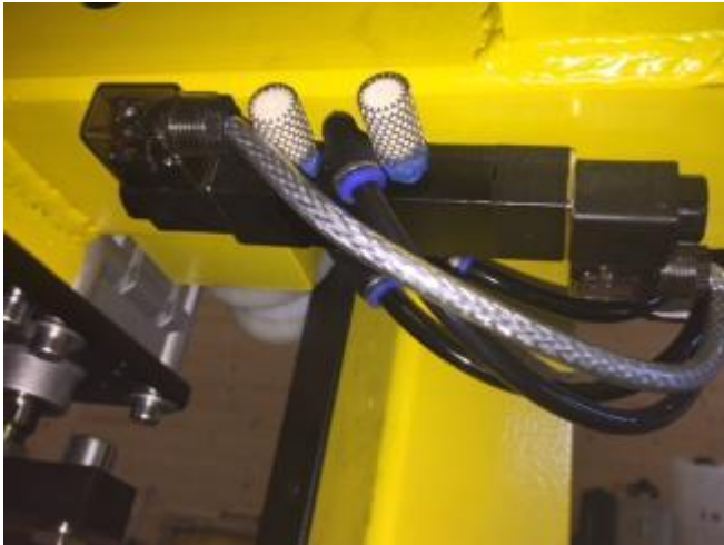
Bild 20: Das Ventil für die Bewegung unten am HLK. In der Nähe vom Zylinder, damit die Bewegungen dynamischer sind.
