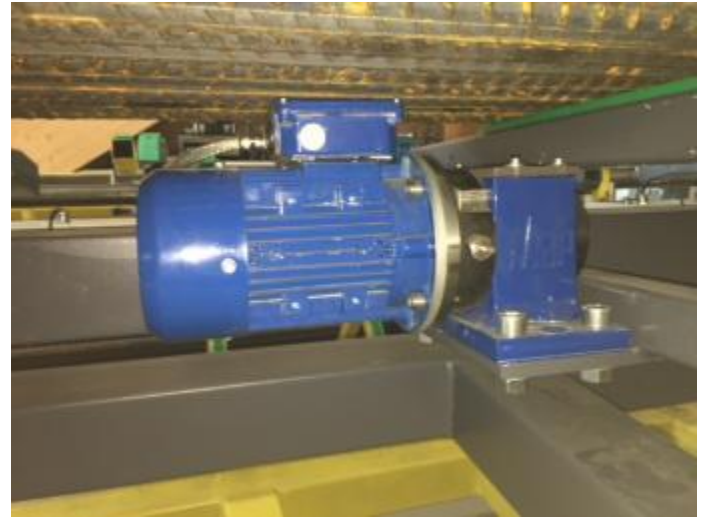
Bild 5: Der Vibrator WIAP V05 sorgt für das. Eingestellt wird dies mit 2 Stk. 6 mm Inbusschlüsseln.
