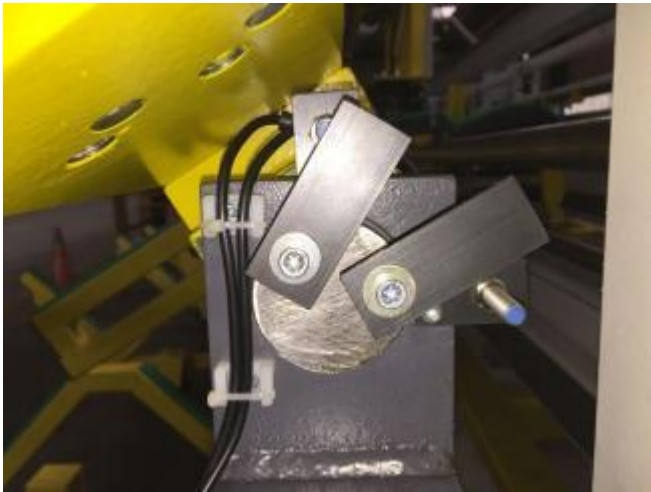
Bild 46a: Die Lage der Ablage wird mit 2 gut einstellbaren Endschalter überwacht.
