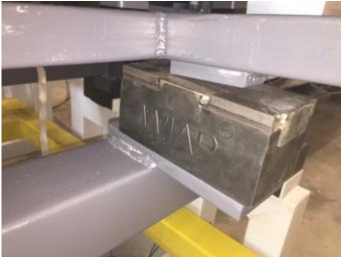
Bild 6: Mehrere Gummis (100 x 120 x 200) sorgen für eine gute Dämpfung, damit keine Vibrationen weiter geleitet werden.
