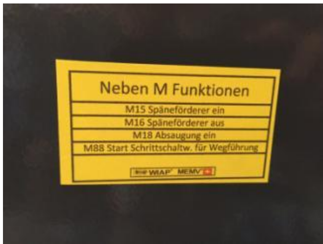
Bild 37a: Der Späneförderer läuft immer nur ein kurzes Stück, damit die Späne hinten in der Steigung genügend abtropfen können, so dass kein Wasser in den Spänebehälter kommt. Es sind immer trockene Späne im Behälter.
