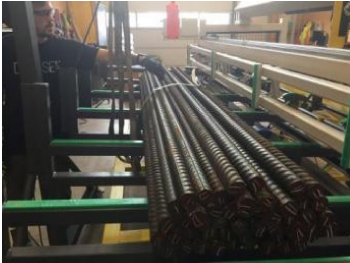
Bild 3: Der Bund wird aufgeschnitten und ohne manuellen Einsatz verteilt er sich selber durch eine besondere Vibrationstechnik. Mittels einem Wiap Vibrator V05 (für Werkstückgewicht bis 5 Tonnen) wird die Verteilung ausgeführt. Der Vibrator kann stufenlos von 0 bis 750 kg Anreger Energie, eingestellt werden.
