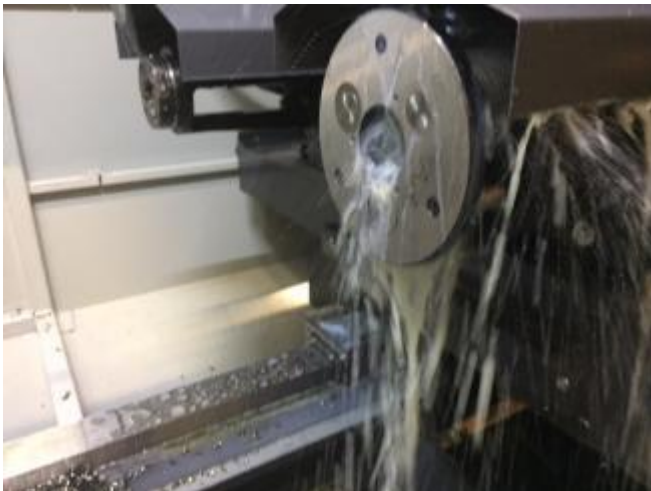
Bild 40: Auch der Rollierkopf wird mit Emulsion gekühlt; M08 ein / M09 aus.
