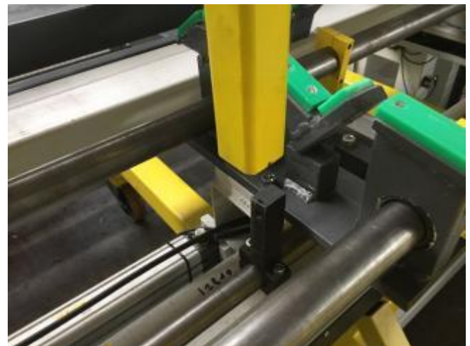
Bild 19: Der Andrücker kann, ohne Schraube lösen, in Sekunden für diverse Werkstück Längen umparkiert werden.
