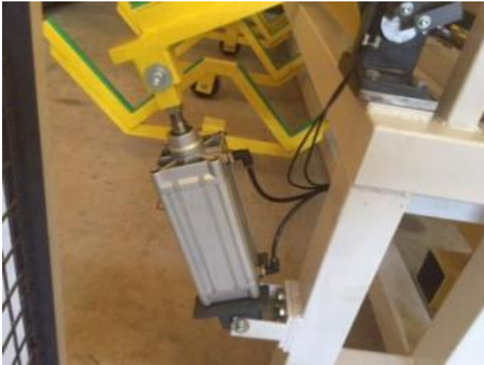
Bild 46: Die Fertigteilablage muss nach oben kommen, um das Fertigteil abzulegen.
