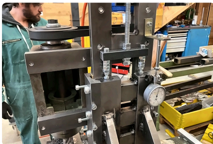
Verstellspindeln aus Gewindestangen, Einstellung mit 0,01-mm-Uhren.
