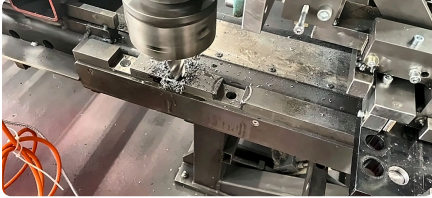
Fräser im Einsatz bei einem Schlitz.
