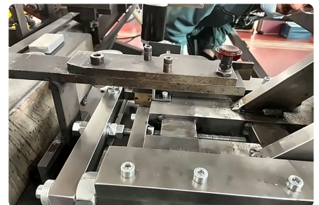
Kaltgezogenes Material und Kunststoff-Gleitbelag.
