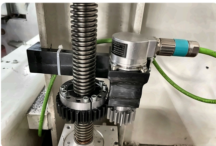
Absolutgeber am zweiteiligen Zahnrad.
