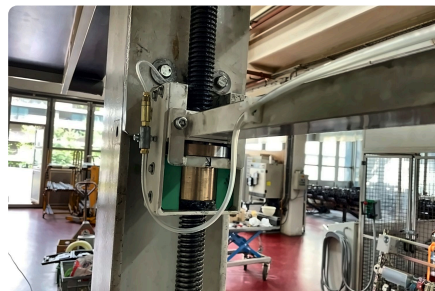
Spindelführung an der Maschine.
