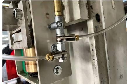
Dosiereinheit pro Spindelmutter.
