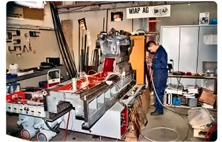
20-Tonnen-Schlitten: neue Belegung, Zahnräder neu eingeschabt.
