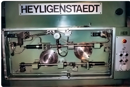
Schaltgestänge mit Zylinderansteuerung.
