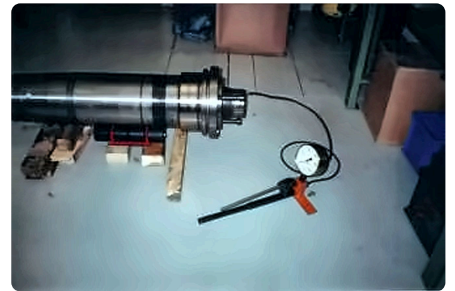
Lager mit Pressverband-Pumpe abgepresst, bis 2500 bar.
