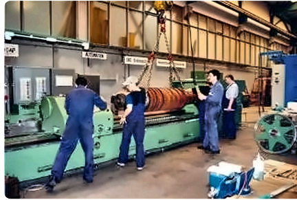
Walzentestdrehen mit Z-Kugelrollspindel 80 × 10.
