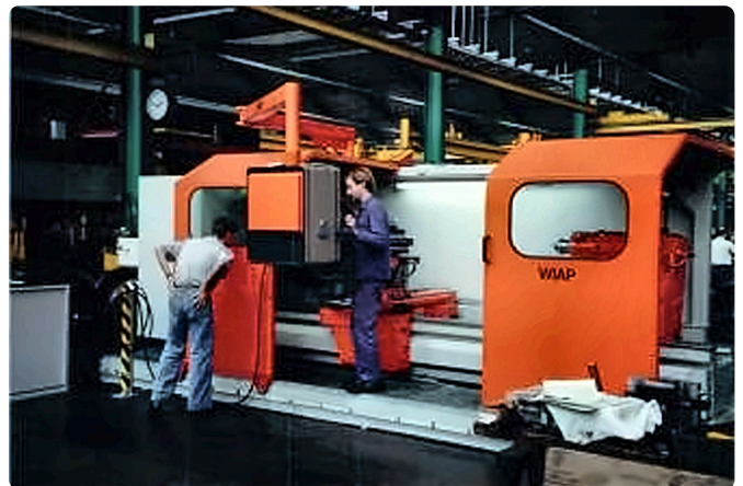
Nachher: CNC-Drehmaschine mit Vollverschalung und Späneförderer.
