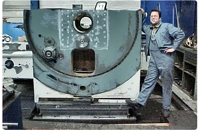
Der gerissene Spindelstock.
