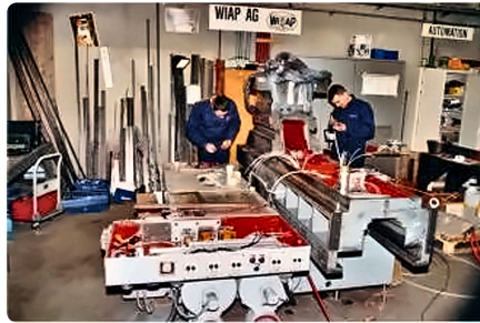
Schlittenführung neu mit SKC belegt.
