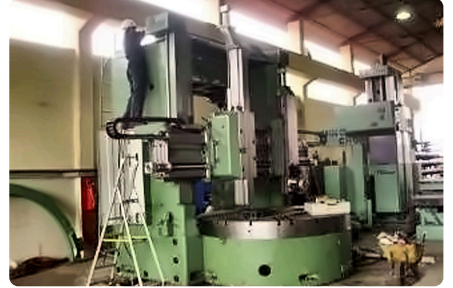
Konventionell vorher, jetzt CNC-gesteuert.
