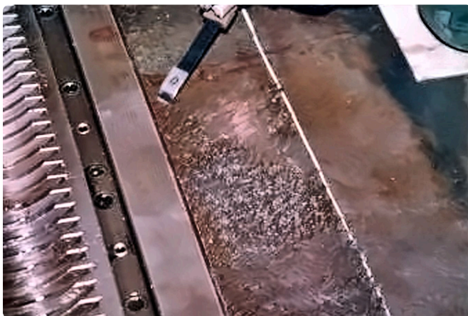
Pro Durchgang trägt man 0,002 bis 0,005 mm ab.
