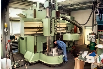
Das Karussell nach dem Umbau.
