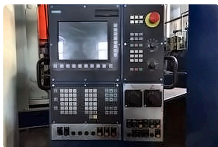
Neue CNC-Steuerung Sinumerik 802 DSL.
