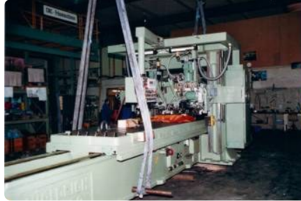
Die Maschine hängt im Kran.
