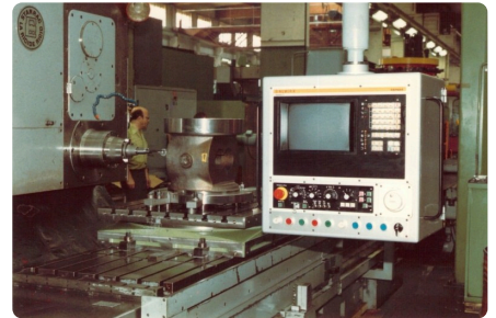
Neue Steuerung, beim Hersteller angebaut.
