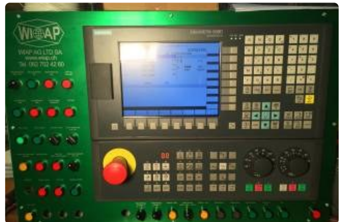
Neue Steuerung mit Bedienpanel.
