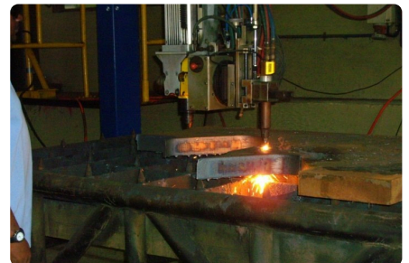
Brennschneiden einer dicken Stahlplatte.
