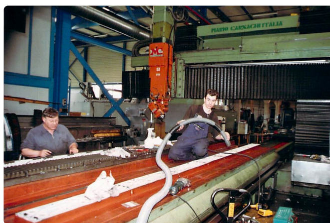
Arbeiten am Gleitbelag: Eine so grosse Maschine braucht viel Kraft.
