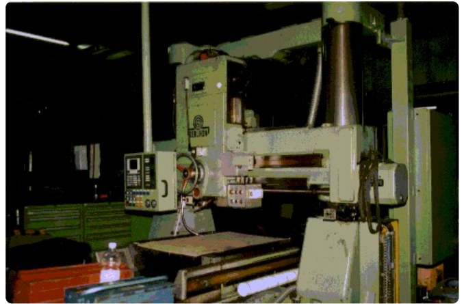
Nach dem Umbau mit neuer Sinumerik-CNC.
