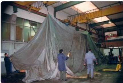
Abdecken über Nacht mit schweren Planen, per Kran.
