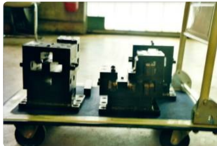
Schwere Stahlhalter, damit keine Eigenschwingung entsteht.
