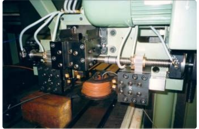
Schlittensystem mit mehreren Stählen im Eingriff.
