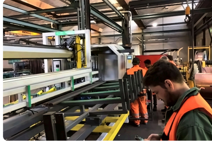
Beladeseite, ausgelegt für 50 Rohlinge.
