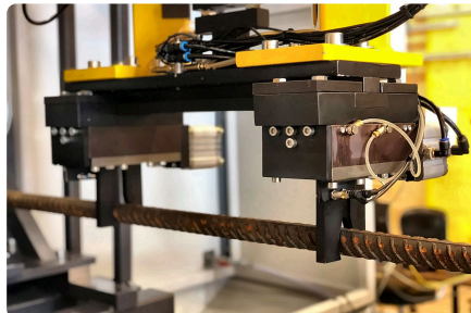
Eigenkonstruktion: HLV-Greifer für Werkstücke bis 40 kg.
