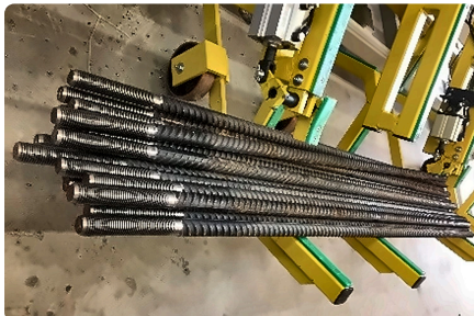
Fertig gerollte Gewinde auf der Ablage.
