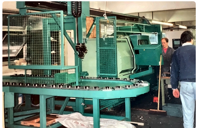
PL2 mit Palettierfunktion und Rundtakt-Palettenbahn.
