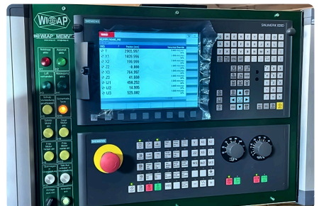
Sinumerik 828 mit WIAP-Bedienpult.
