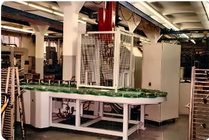
Eigen entwickelter Roh- und Fertigteilsspeicher.
