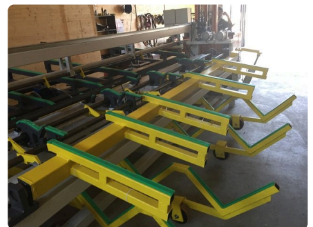
Absenkrechen für Stangen von 1 bis 4 m, ohne Gewindeschäden.
