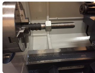
Gewindekontrolle direkt in der Maschine.
