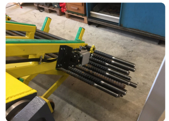
Fertig geschälte und gerollte Gewinde.
