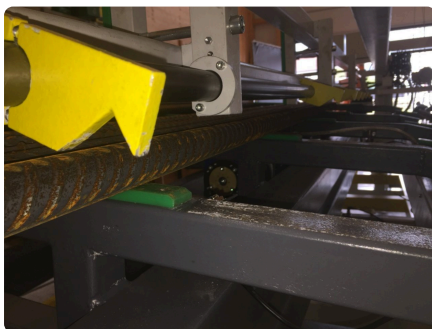
Kralle hebt die Stange auf das Prisma.
