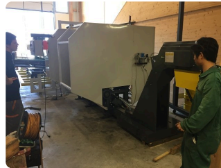
Späneförderer unter der Maschine.
