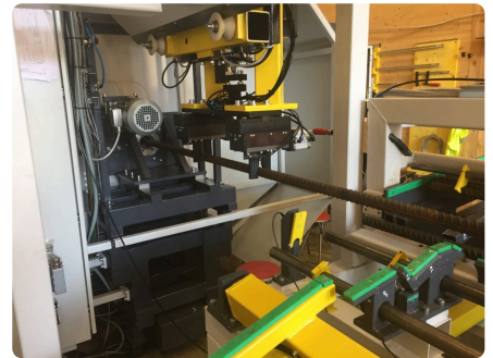
Portallader HLV hält Rohteil und Fertigteil bereit.
