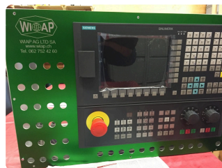
CNC-Frontplatte nach dem WIAP-System (Sinumerik 808).
