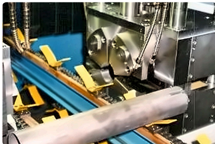
Schnellwechsel-Spannsystem für zentrische Rohraufnahme.
