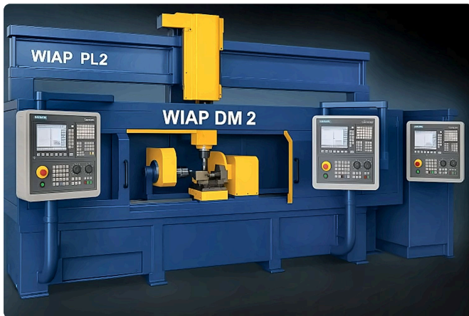
Doppelseiten-Drehmaschine WIAP DM 2 mit Portallader PL 2. VISUALISIERUNG
