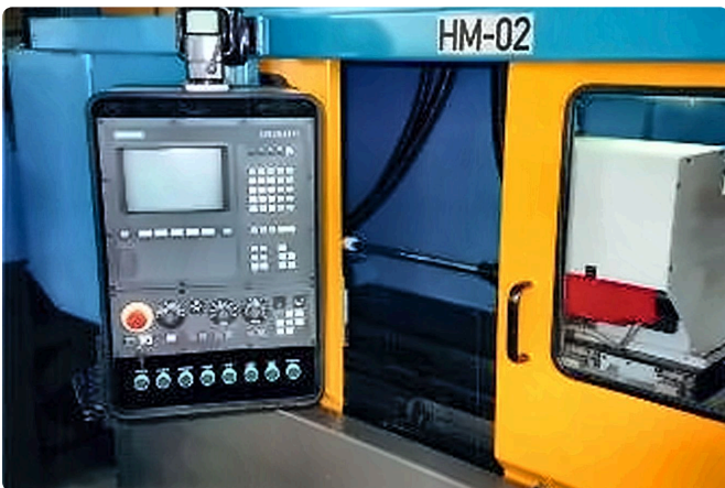
Steuerung: Sinumerik 810T GA2.
