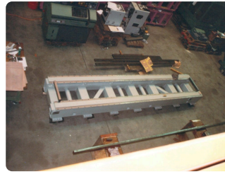
Maschinenbett vor der Montage.
