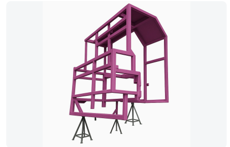
Rahmenkonstruktion der Verschalung. VISUALISIERUNG
