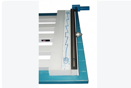
Kreuzschlitten mit Luftunterstützung. VISUALISIERUNG
