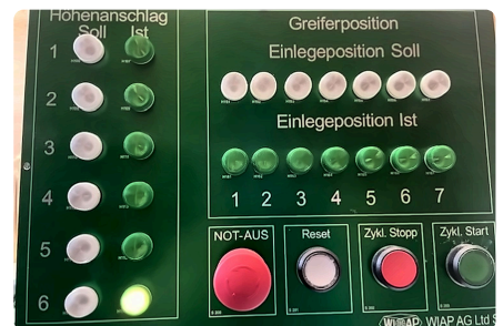
Anzeige für Höhenanschlag und Greiferposition.
