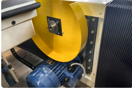
Sägeblatt mit Abdeckung.
