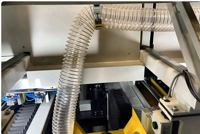
Absaugschläuche an den Fräseinheiten.
