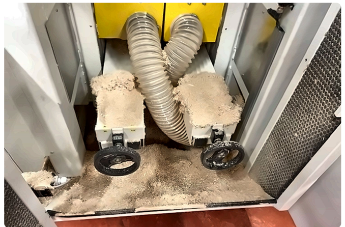
Späne im Arbeitsraum nach intensiver Bearbeitung.
