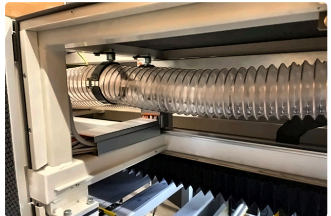
Absaugschlauch im Arbeitsraum.
