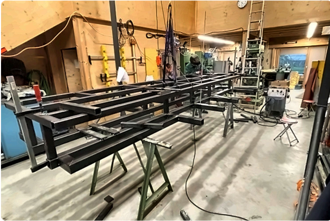
Schweisskonstruktion des Gestells in der Halle Dulliken.
