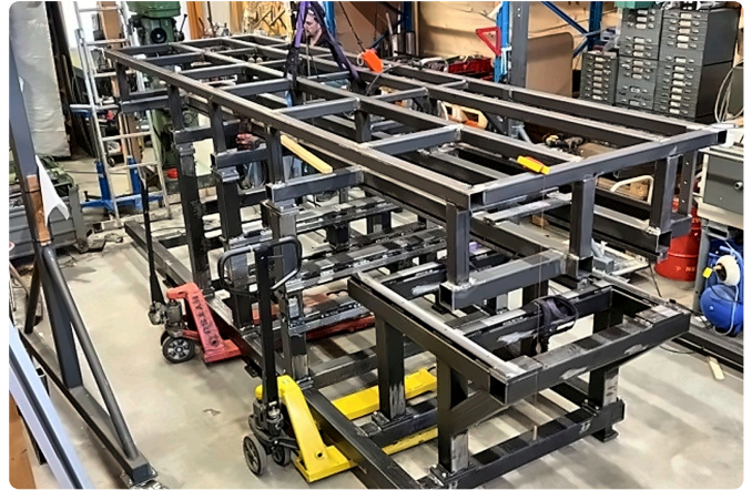
Untergestell mit Konsolen, bereit für die weiteren Schritte.
