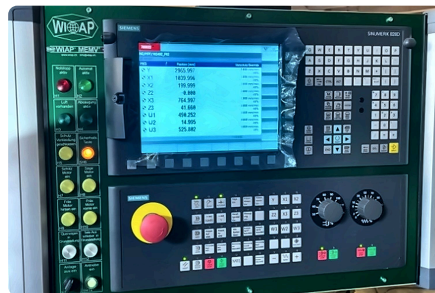
WIAP-Bedienpult mit Sinumerik.
