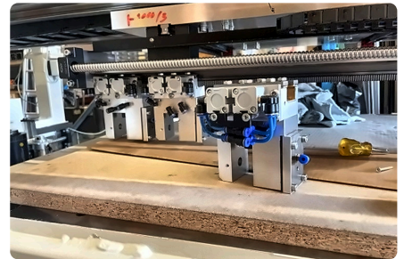
Greifer an der Schlittenführung.
