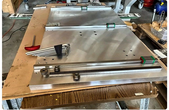
Grosse Platte aus Aluminium 7075 für den Y-Schlitten.
