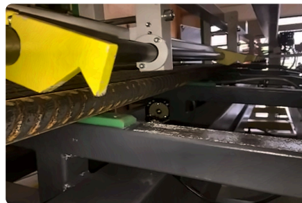
Kralle: Stange vom Rechen auf das Prisma.
