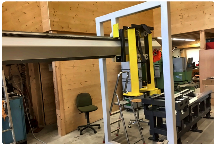
Hub-Senk-Schlitten mit V-Rollen, geführt auf zwei Vierkantrohren.
