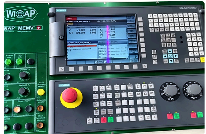
WIAP-Bedienpult mit Sinumerik 828.
