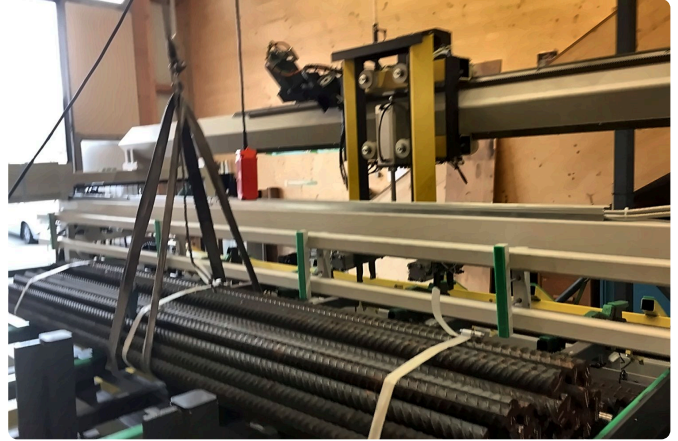
Rohteilbund mit 50 Ankerbolzen von rund 4 m Länge, zusammen ca. 2 t.
