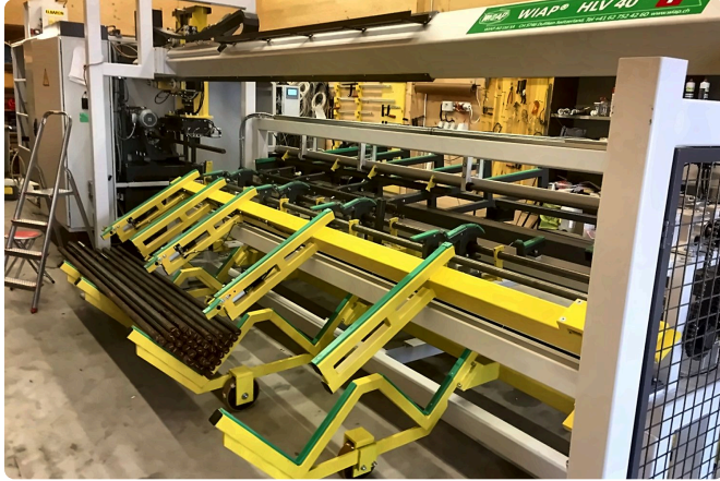
Der HLV-Lader mit der gesamten Automation.
