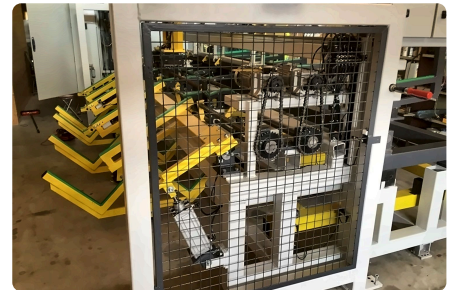
Schutzgitter: kein Zugang in die Gefahrenzone.
