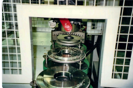
Rundtaktband mit zentraler Spannvorrichtung.
