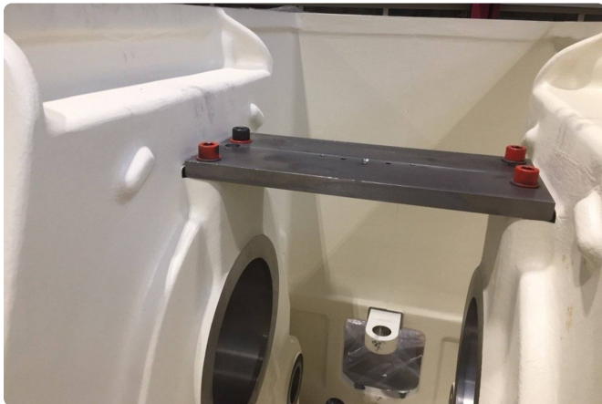
Die Mittenplatte ist festgeschraubt und verstiftet. Ohne sie driften die Seitenwände um über 1,5 mm auseinander.
