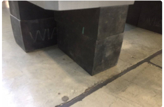
Doppelte Gummiunterlagen, 200 mm hoch, unter jedem Fuss.
