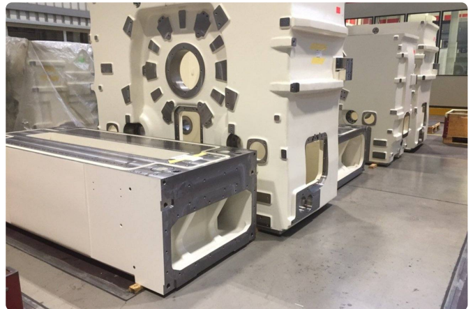
Mehrere Maschinenständer aus Guss in der Halle.
