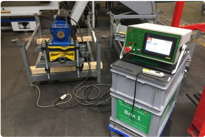
Aufbau mit Erreger und Steuergerät auf der Werkzeugbox.
