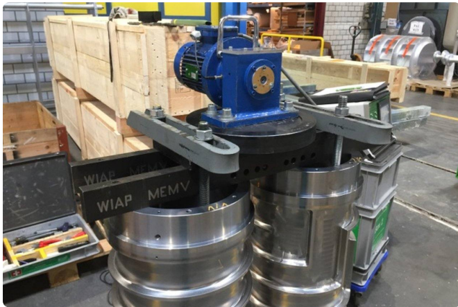
Mehrrichtungssystem auf zwei Walzen: Erreger auf der Spannvorrichtung (Aufspannart 2, Mittenpressung).
