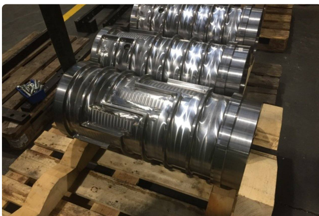
Walzen mit gefrästen Kühlkanälen vor der Behandlung.
