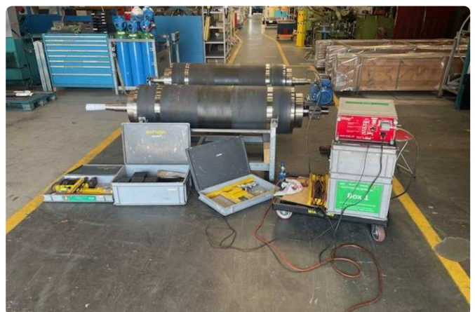
Zwei Walzen werden gleichzeitig mit WIAP® MEMV® VSR behandelt.
