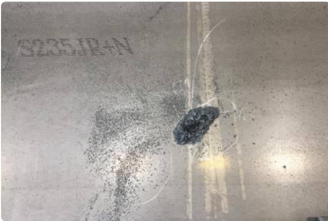
Ermittlung des Totpunkts mit Streusand: Wo der Sand zusammenläuft, ruht die Tafel.
