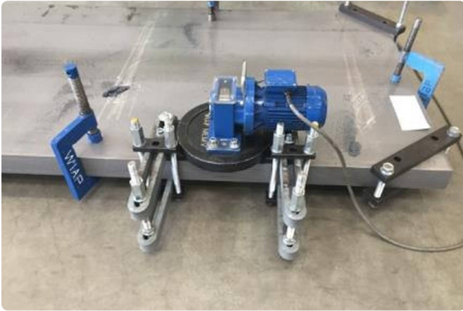
XY23: Erreger und Klemmung auf der Tafel.
