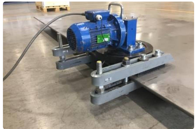
Der Erreger V20 an der Kante einer Blechtafel befestigt.
