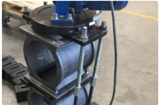
Gussgehäuse in der gestapelten Aufspannung.
