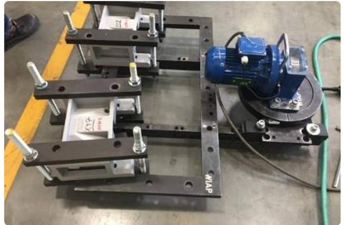
Gusslager in der Mehrfachaufspannung mit Erreger.
