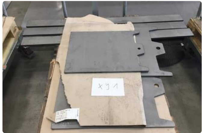
Ausgelaserte Teile aus einer behandelten Tafel.
