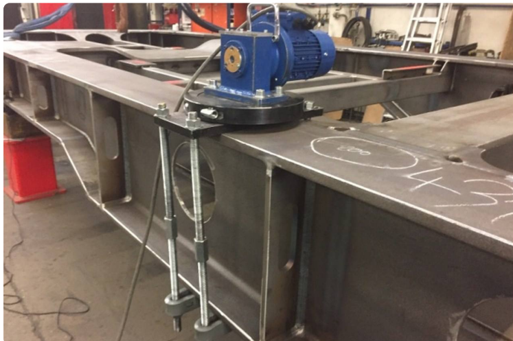
Der Anreger wird mit 4 × M24 / 8.8 angeklemt, je rund 17 Tonnen.
