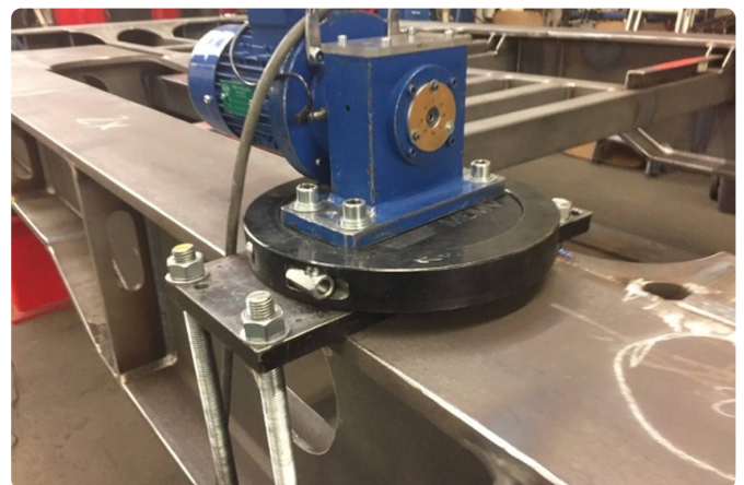
Anreger auf der Grundplatte: Vibrieren in vier Richtungen.
