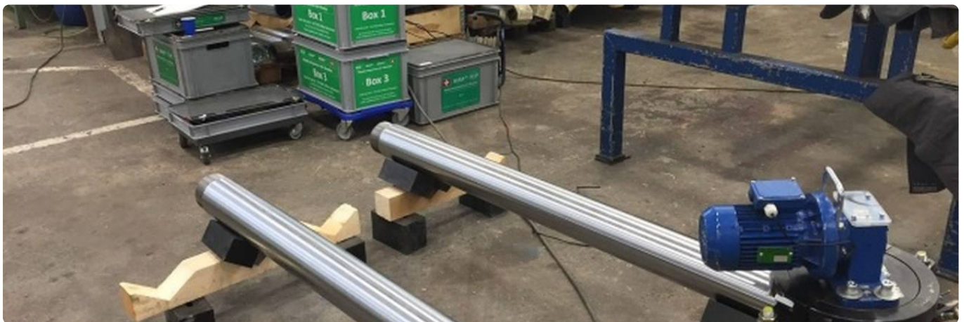
Arbeitsplatz: Kolbenstangen auf Auflagen, Erreger auf der Stange, daneben das Steuergerät.
