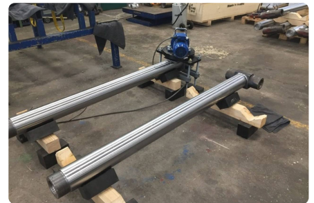
Kolbenstangen auf Holzprismen mit Gummi.
