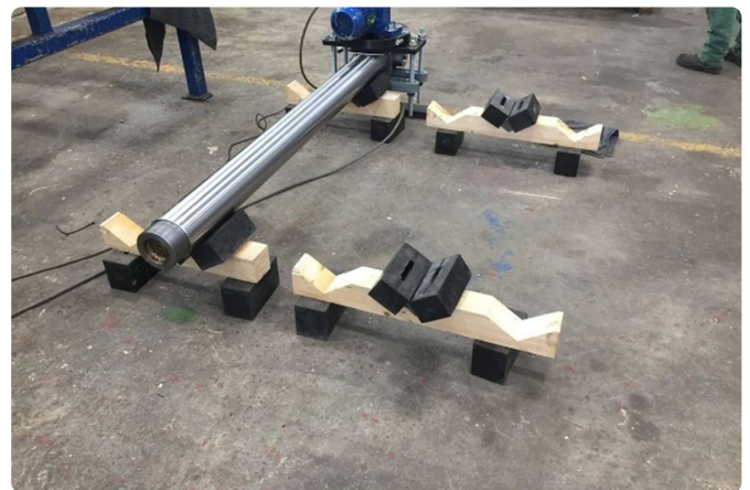
Zwei Kolbenstangen auf Auflagen, Erreger auf einer der Stangen.
