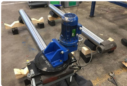
Der Erreger auf der Spannvorrichtung an der Stange.
