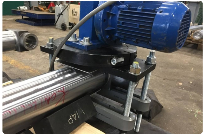
Der Erreger auf der Spannvorrichtung, mit Gewindestangen und Querbalken.
