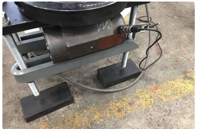
Am Boden: Gummiunterlagen und Gewindestangen der Spannvorrichtung.
