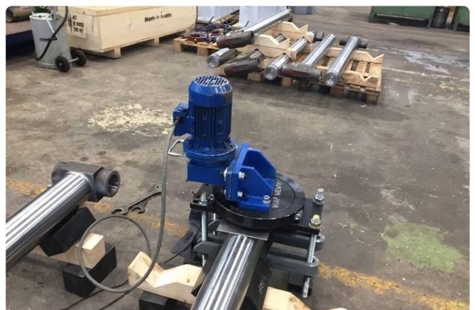
Kolbenstange auf Auflagen, Erreger am oberen Ende.
