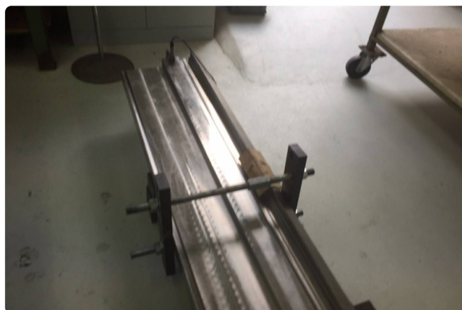
Gewindestange mit Platten spannt quer über das Profil.
