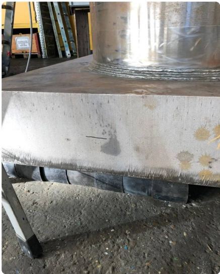
Das Bauteil liegt auf den Gummis auf.
