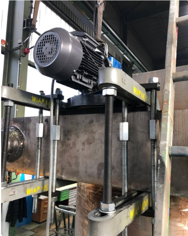
Der Anreger V50 ist aufgespannt, Klemmkraft über 60 Tonnen.
