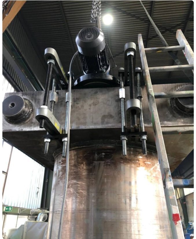
Robustes, schwer gebautes Bauteil mit Anreger V50.
