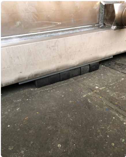
Die Gummis werden um rund 27 % zusammengedrückt.
