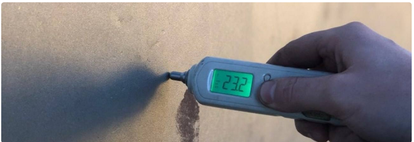
Gute Anregung: über 2 G am Messpunkt, mit dem Handmessgerät erfasst.
