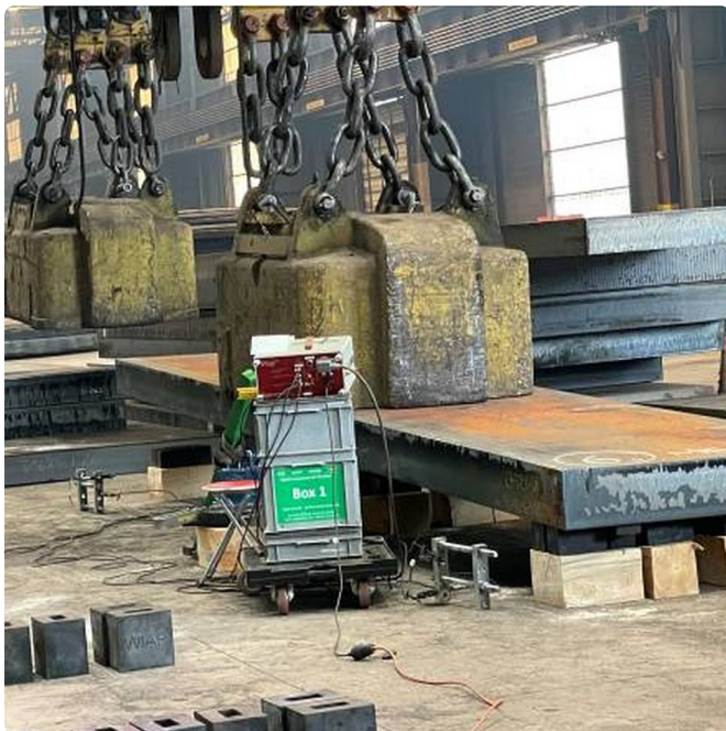
Magnete von je 10 Tonnen heben und verschieben Platten. Daneben steht das Steuergerät.
