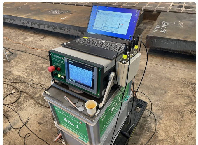
Steuergerät mit Laptop: Das Protokoll wird direkt auf dem Laptop abgelegt.
