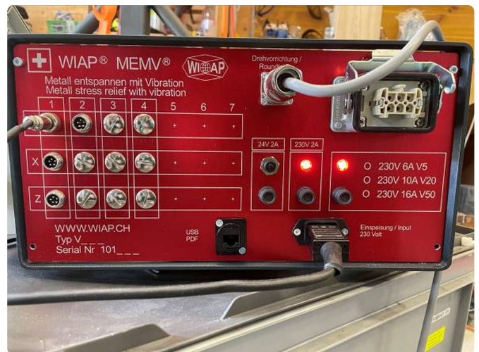
Das Steuergerät von vorn: Sondenanschlüsse für X, Y und Z, Anschlüsse für Drehvorrichtung und Motor, USB für den Protokolldruck.
