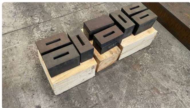
Gummiunterlagen 100 × 200 × 120 mm auf Holzbalken.
