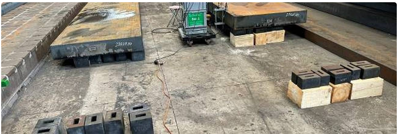
Gerichtete Platten in der Halle: Das Steuergerät steht neben der Platte, im Vordergrund liegen die Gummiunterlagen.
