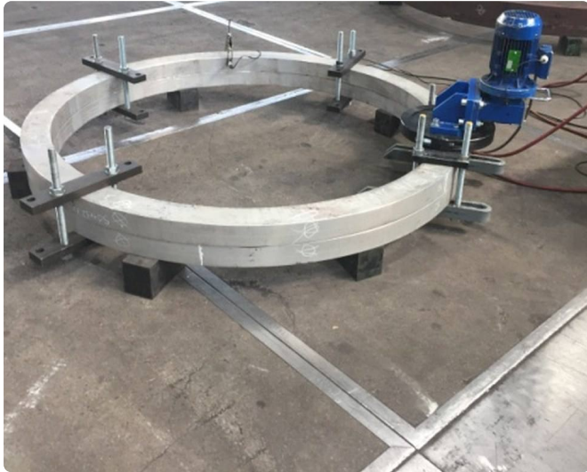
Zwei Aluminiumringe, gut zusammengeklemmt, daneben der Vibrator. Es gibt verschiedene Klemmtypen.
