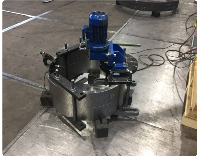
Vibrator V20 auf einer Klemmvorrichtung am Ring.
