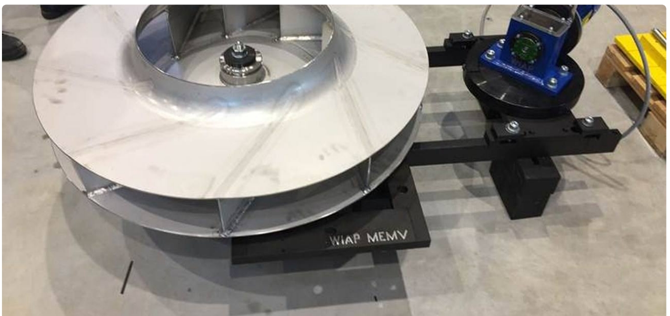
Sonder-Impeller aus Duplex-Stahl auf der Mehrfachaufspannvorrichtung, der Vibrator sitzt seitlich. Er wurde in vier Richtungen entspannt.
