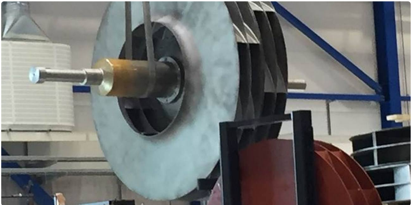
Einer der grössten behandelten Impeller auf dem Weg zur Auswuchtmaschine.
