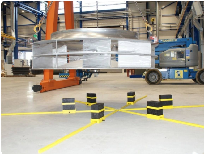
Der Impeller liegt auf den gesicherten Gummiauflagen der Sternauflage.
