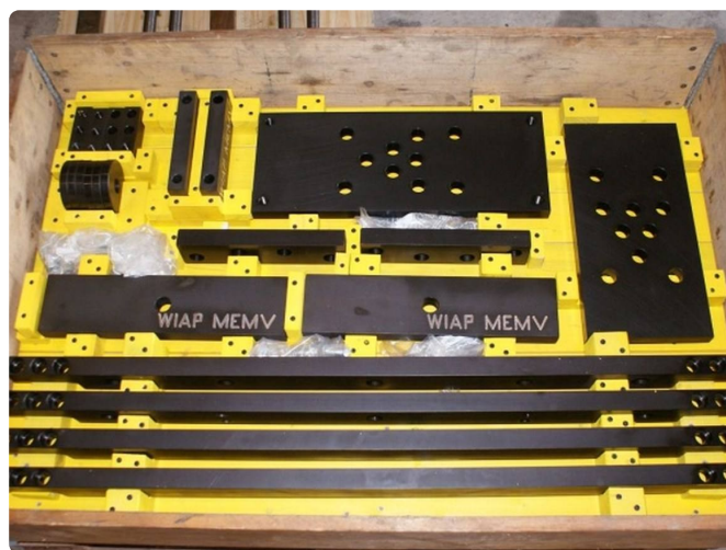
Die Vorrichtungen in der Transportkiste: Axial- und Mehrfachaufspannvorrichtung.
