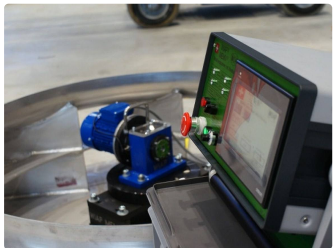
Steuergerät, dahinter der Vibrator V20 im Impeller.
