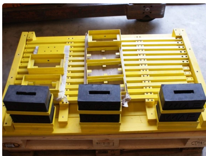
6-Arm-Sternauflagevorrichtung mit Gummiauflagen und Transportvorrichtung.
