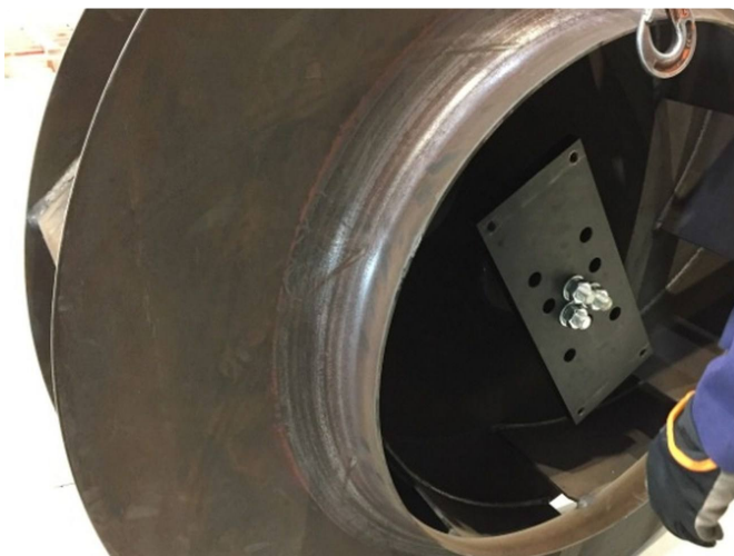
Axial-Aufspannvorrichtung in der Nabe: Anregung der Sternnabe von innen.
