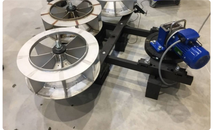
Drei Impeller Ø 500 mm auf der Mehrfachaufspannvorrichtung. Auch sie werden in 2D, 3D, 4D und 5D entspannt.
