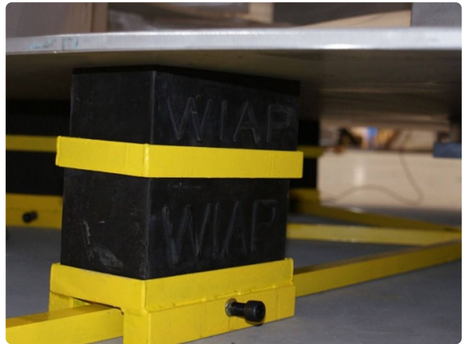
Gummiauflage mit Sicherung gegen Wegrutschen bei Resonanz.
