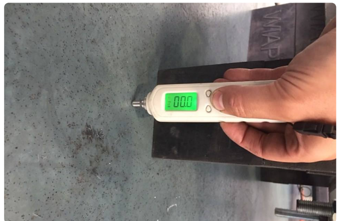
Messgerät am Boden: 0,0 m/s 2 , keine Schwingungsübertragung.
