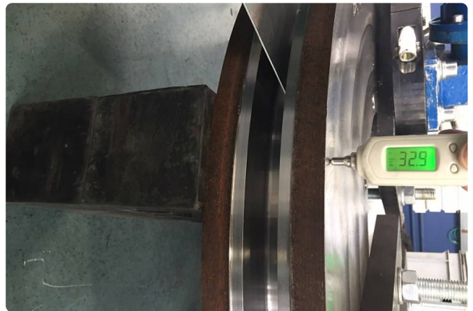
Aluminium zwischen den Ringen. Messung am oberen Ring: 32,9 m/s 2 (3,29 G) Anregung.
