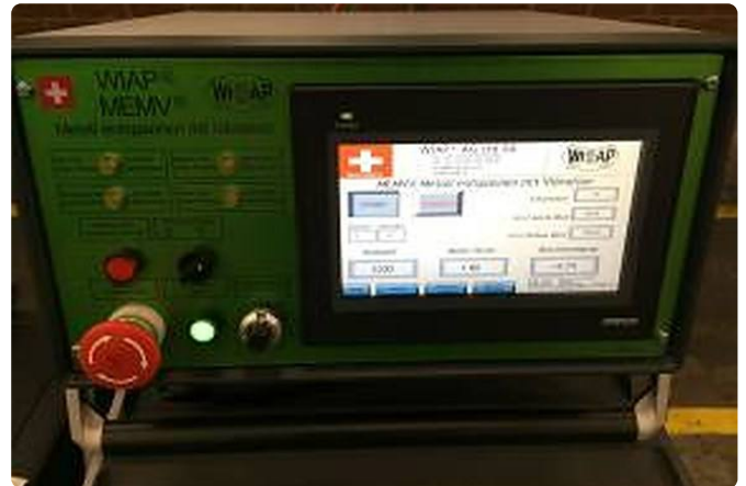
MEMV VSR Steuergerät: Es führt den Prozess automatisch aus.
