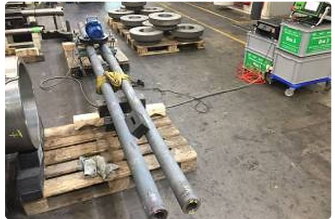
Zwei kleine, lange Rohre in der Doppelspannung.
