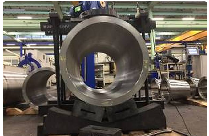
Das Grossrohr in der Aufspann-Drehvorrichtung.
