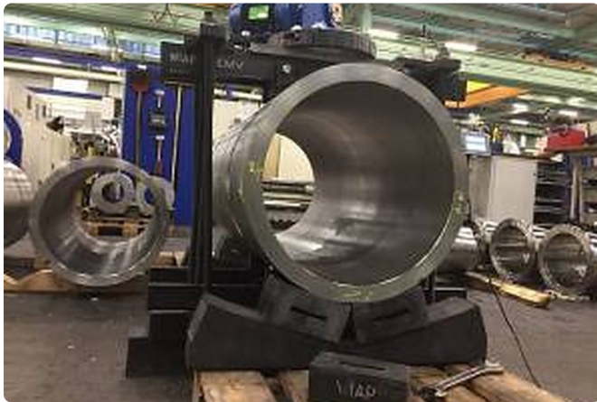
Grossrohr stehend aufgespannt, bereit für den Prozess mit drei Durchgängen.
