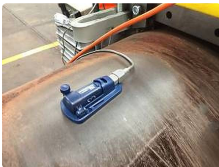
Datenlogger: je Messposition drei Achsen.
