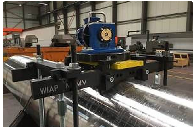
Erreger und Aufspannung auf einer Walze, bereit für die Behandlung mit dem MEMV VSR Verfahren.
