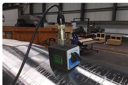
Sonde für die Prozessermittlung, zusammen mit der Motorstromaufnahme.
