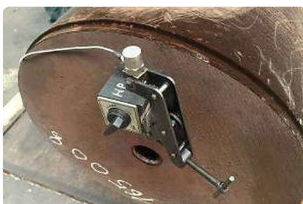
Messaufnehmer an der Stirnseite der Walze (herkömmliche Messmethode).
