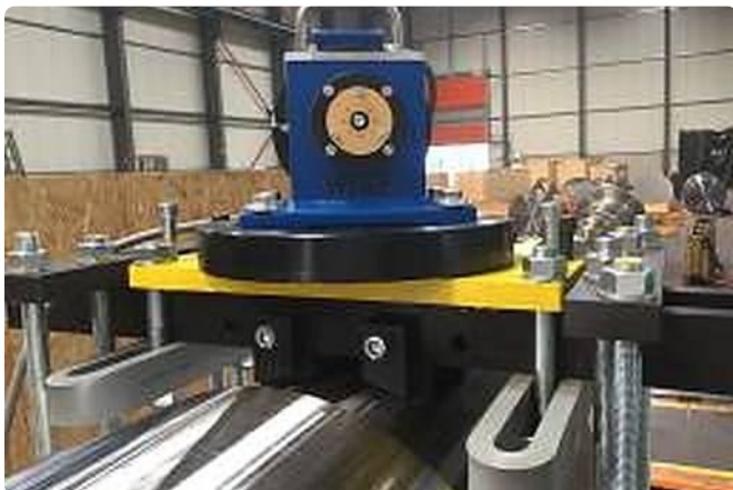
Erreger und Vorrichtung in der Seitenansicht.
