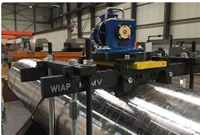
Erreger auf der Walze: Die Vorrichtung ist über Spannrahmen und Gewindestangen mit der Walze verbunden.
