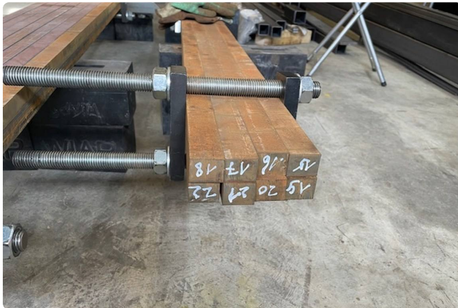
Ein Bund mit 8 Teilen, mit Gewindestangen und Platten zusammengespannt.
