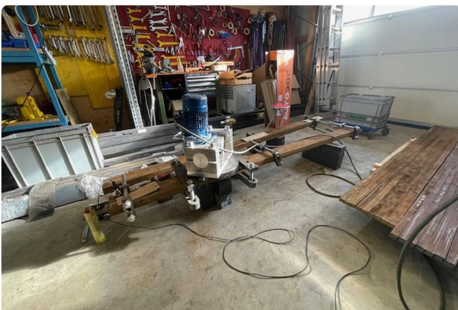
Aufbau: der Erreger sitzt auf den Flachstäben, die auf Unterlagen liegen.
