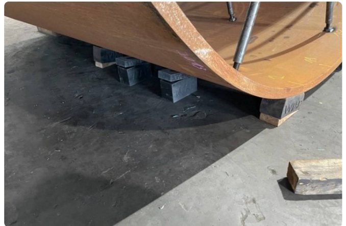
Der Zylinder auf den Gummiunterlagen, teils doppelt unterlegt.
