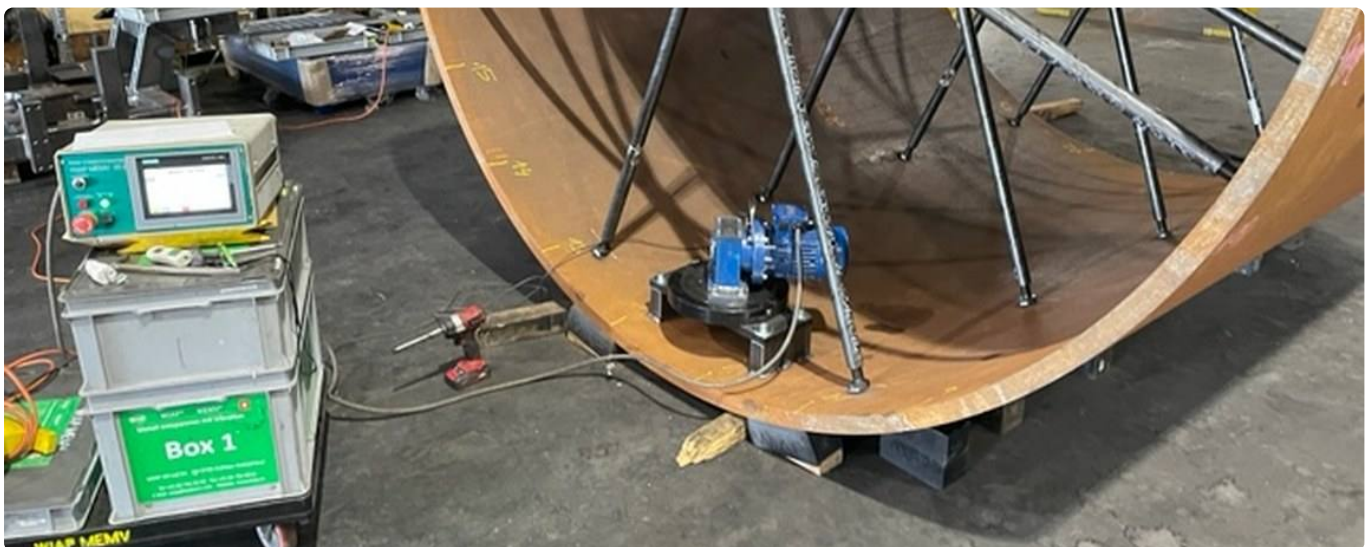
Der gerollte Zylinder mit Verstrebungen wird vor dem Vordrehen vibriert. Links das Steuergerät, im Zylinder der Erreger.
