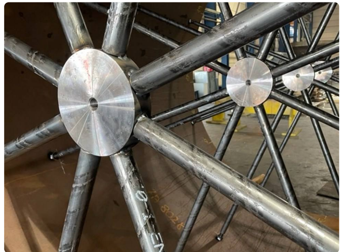
Verstrebungen: je 4 Streben pro Ebene, in der Mitte über Naben verbunden.
